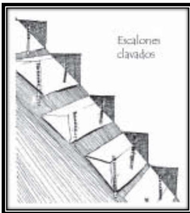
Gráfico 11. Escalones de madera asegurados a una pared de roca con varillas de acero
