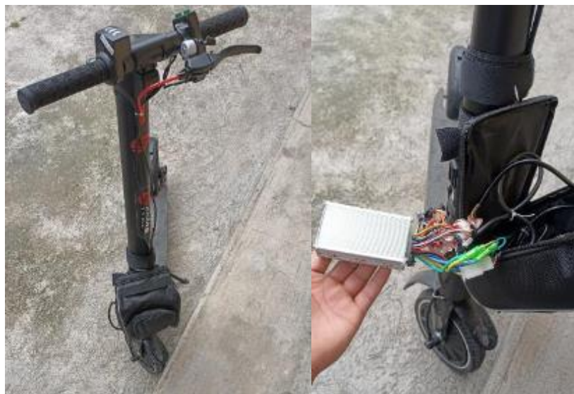
Nuevo Controlador instalado y sus conexiones
