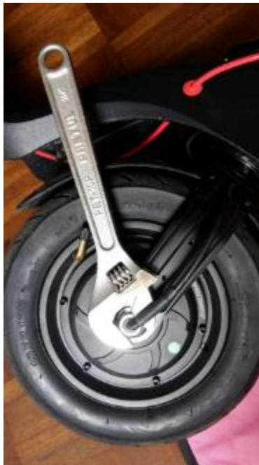
Extracción de Tuerca Lado Derecho de la Rueda
