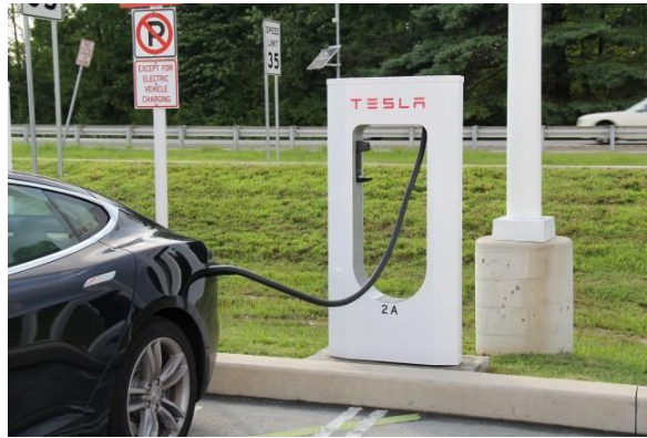
Figura 2-4. Ejemplo de recarga rápida con un supercargador Tesla de hasta 120 kW [20]
