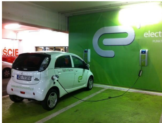
Figura 2-3. Ejemplo de recarga semi - rápida en un centro comercial del Mitsubishi i-MiEV [19]
