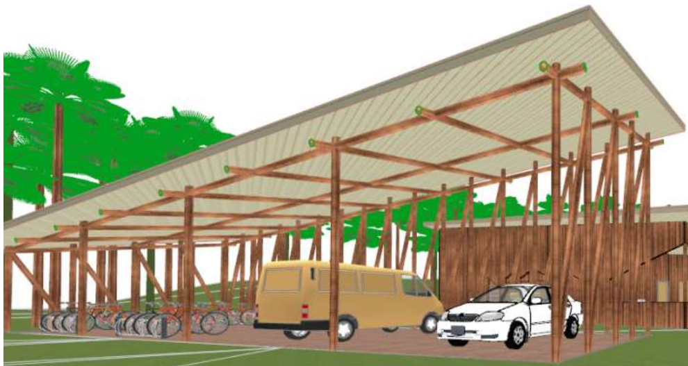
FiguraN°32: Estructura de Vigas para asentar el Calcreto Elaborado por los autores
