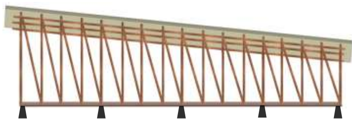
Figura N°31: Módulo con plintos de hormigón y columnetas de Guadua. Elaborado por los autores
