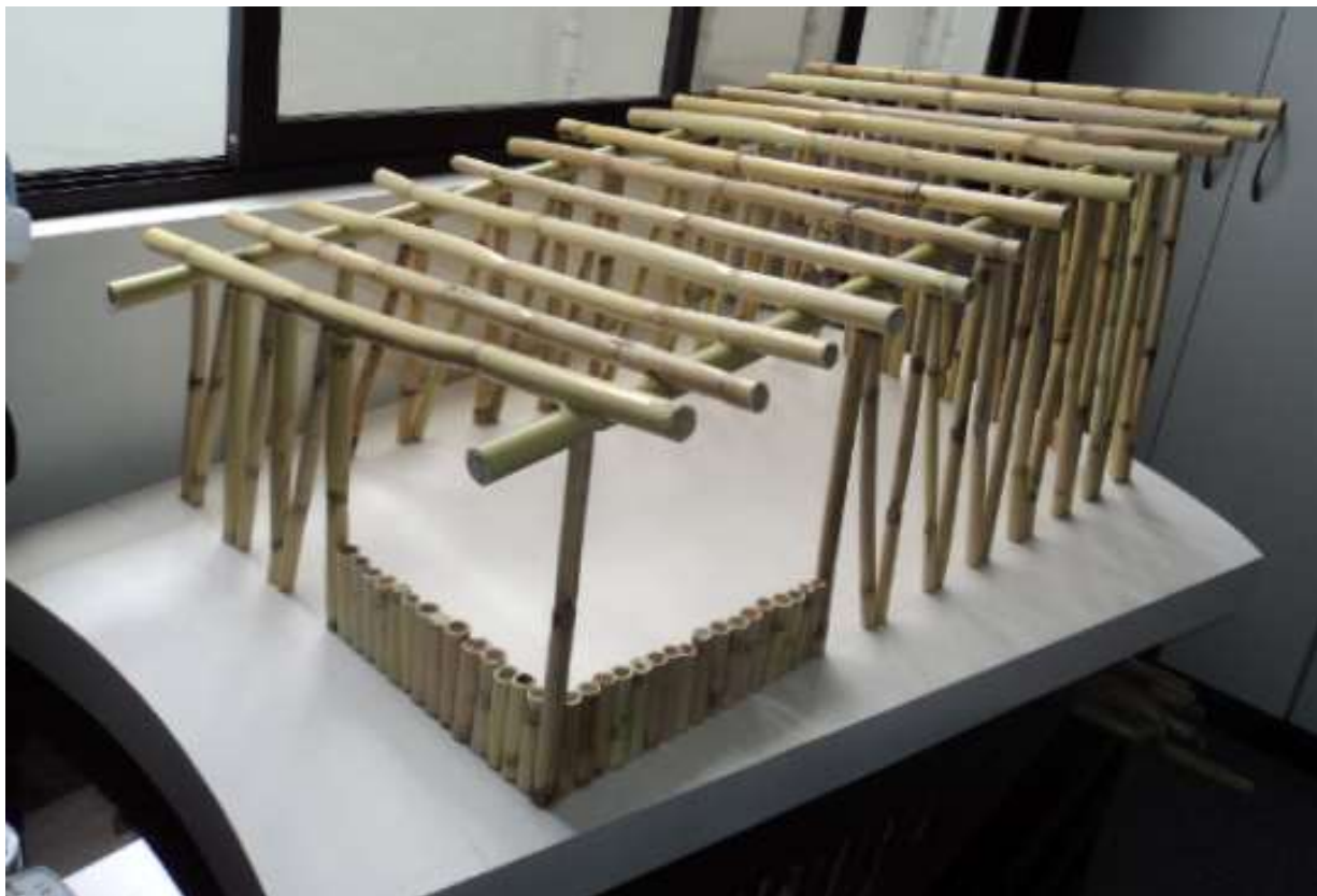
FotografíaN°27: Colocación de mampostería de Guadua en los espacios abiertos de las cerchas Tomada por los autores
