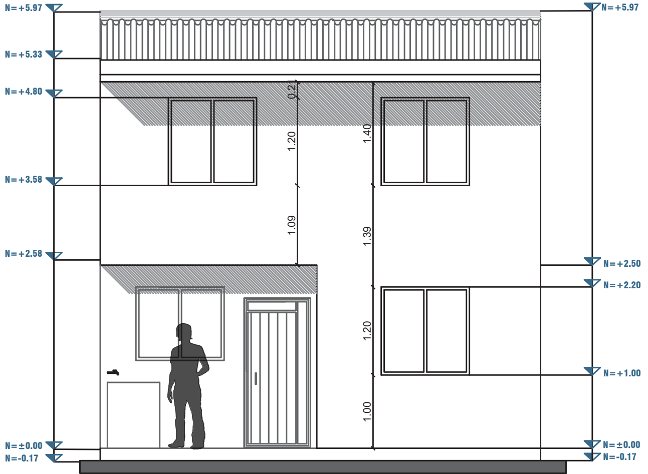
Figura 115. Fachada posterior actual Nota: Elaborado por el autor
