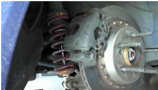
Disposición "coil-over" Amortiguador telescópico + Muelle
