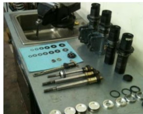
Figura 7: Componentes desarmados de un amortiguador
