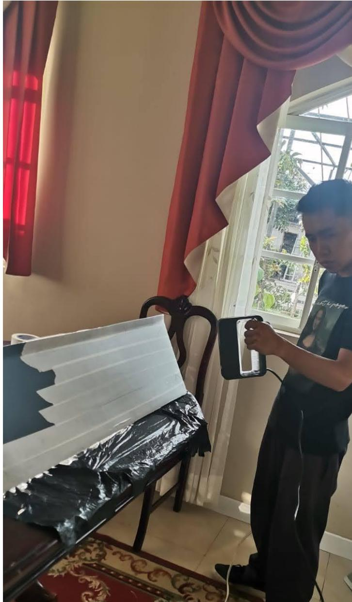
*Nota: digitalizando los alerones comerciales para el vehículo Suzuki forsa 1. Tomada de autor, 2022.*
