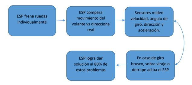
El sistema de control de tracción electrónico (ESP) se vale de los sensores de velocidad de rueda, sensores de ángulo de giro y dirección para comparar el movimiento del volante dado por el conductor contra el movimiento real del vehículo, que dicho sea de paso, deben ser el mismo, si ocurre que el vehículo se va en una dirección diferente a la deseada por el conductor, el sistema ESP hace las correcciones pertinentes, por medio de las ordenes que envía la centralita
