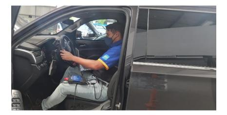
Para la prueba con escáner automotriz en la camioneta Chevrolet Dmax 2020 se utilizó la interfaz IDSS Diagnostic Service System tal como se muestra en la figura 27 y se procede con los siguientes pasos:
