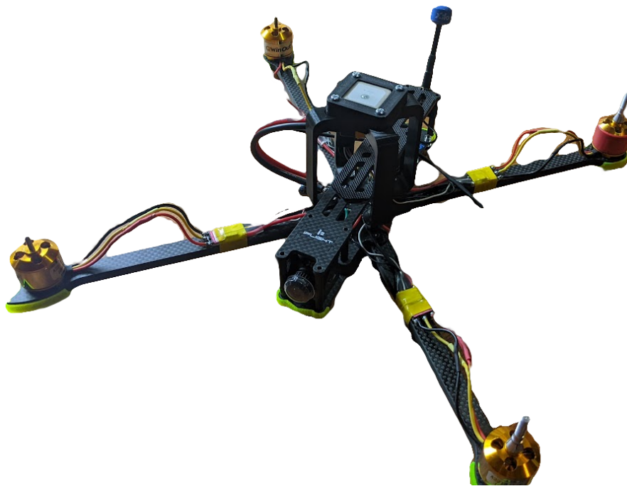
Figura 44. Ensamblaje preliminar de la estructura principal y el circuito electrónico
