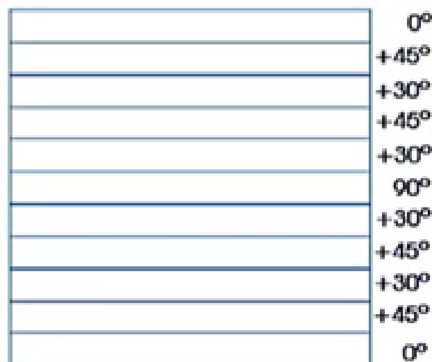
Figura 10. Ejemplo de laminado simétrico, Fuente: [8]
