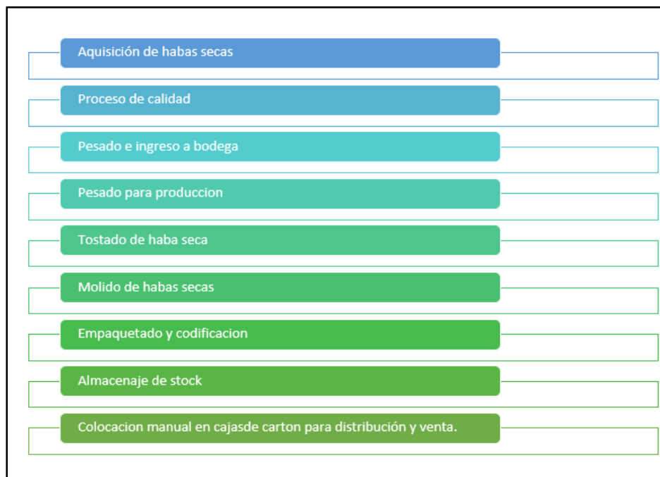
Figura 32. Diagrama de bloques de elaboración.
