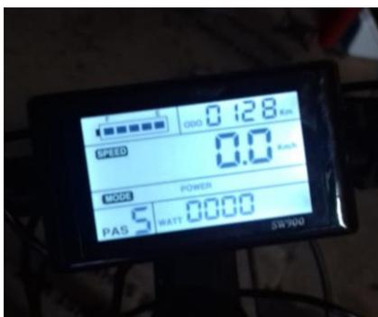
Nota: Pantalla LED, indica carga batería kilómetros recorridos, velocidad, watts aportados por el motor y el nivel del sensor PAS
