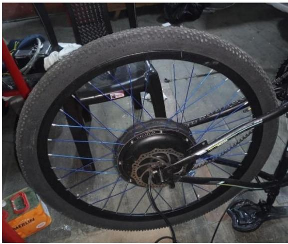
Una vez instalado y asegurado el motor se procede a fijar todos los elementos externos como frenos y marchas posteriores.
