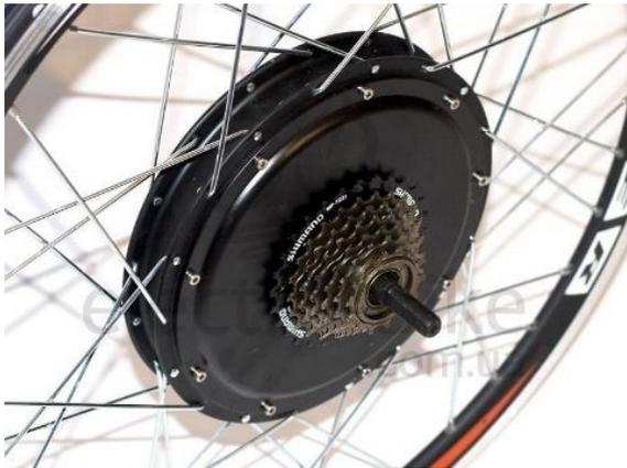
Nota: En la figura se muestra el tipo de motor HUB sin engranajes. (Majdalani, AZ adsl zone, 2021)
