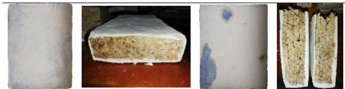
Tipo V: Yeso + Módulo de totora (Pegado en paralelo) + recubierto de resina epóxica + envuelto en malla metálica + Yeso
