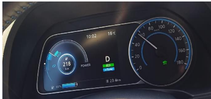
Figura A. 11. Sistema Eco y E-pedal activados Fuente: (Albuja & Puenguenan, 2022).
