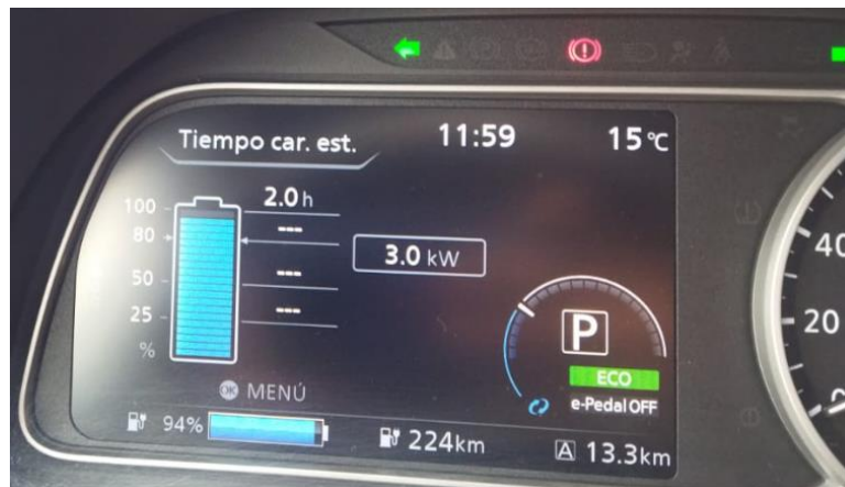
Figura A. 9. Tiempo de carga de la batería Fuente: (Albuja & Puenguenan, 2022).
