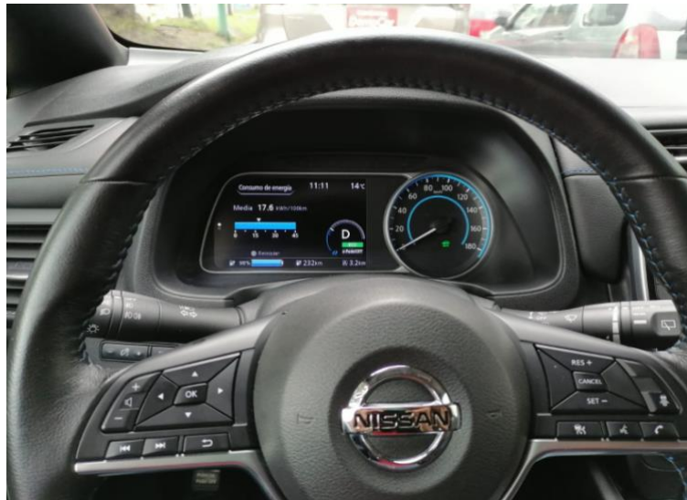
Figura A. 8. Consumo de energía con modo ECO a los 3,2 km de recorrido Fuente: (Albuja & Puenguenan, 2022).
