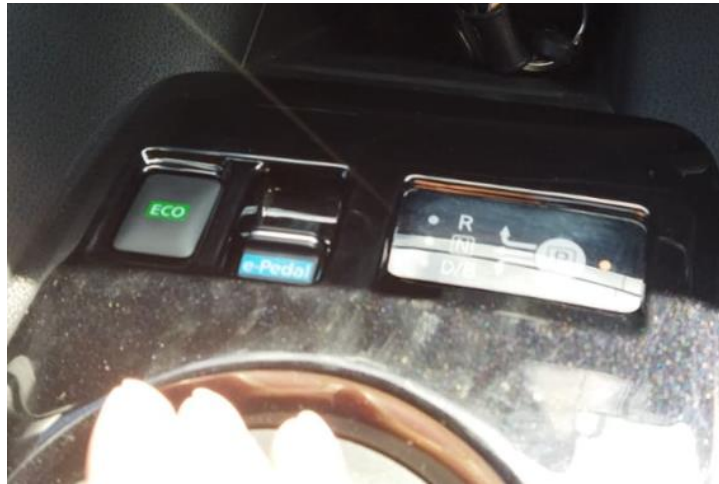
Figura A. 10. Activación sistemas Eco y E-pedal Fuente: (Albuja & Puenguenan, 2022).
