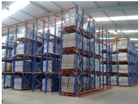
Ilustración 11: Sistema de almacenamiento drive through
