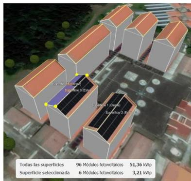
**Figura 15. Ubicación paneles solares Inversor 1**
