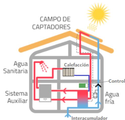
**Figura 36. Esquema de sistema de circulación forzada.**
