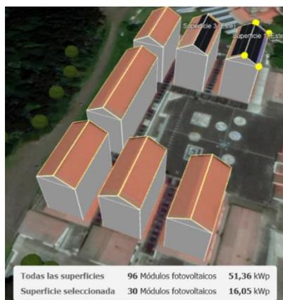
**Figura 17. Ubicación paneles solares Inversor 3**
