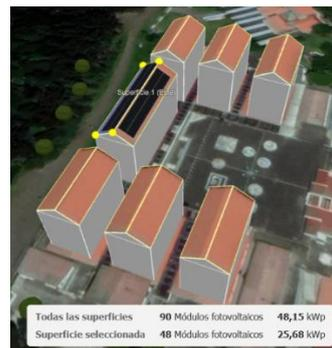
**Figura 19. Ubicación paneles solares Inversor 5**
