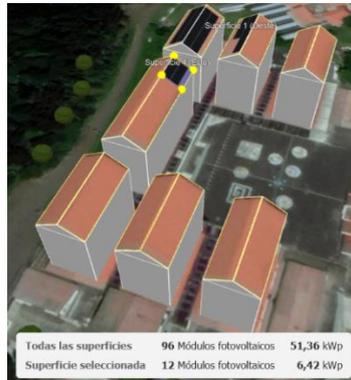
**Figura 18. Ubicación paneles solares Inversor 4**
