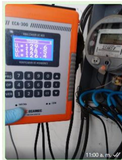
**Figura 29 Verificar precisión del contador**
