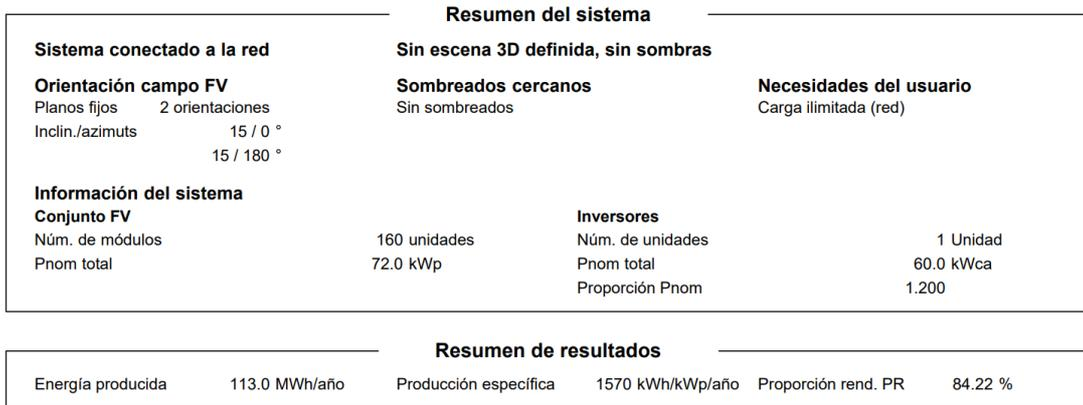
**Figura 11 Resultados del diseño en PVsyst**
