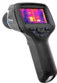
**Figura 27 Cámara termográfica**
