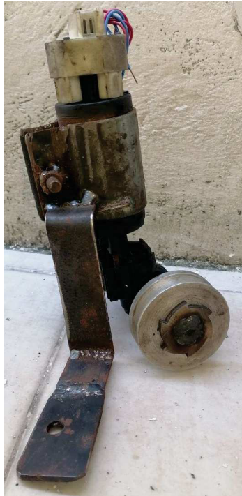
Figura 100. Motor de Sistema de Arado con Carcasa para Unir a Estructura Principal
