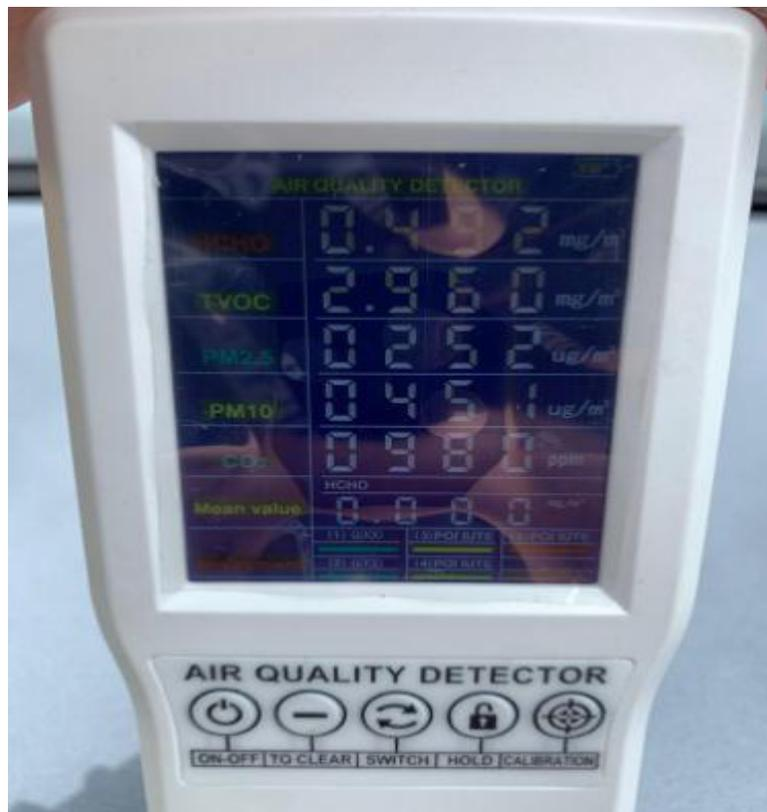
**Anexo 4.2.1.2.** Toma de datos dentro de la cabina con filtro usado.
