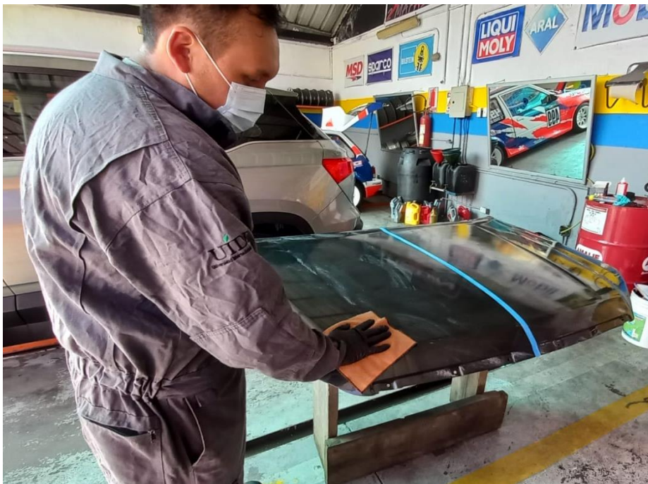
Figura 4.29. Corrección de pintura por secciones (Autores 2022)
