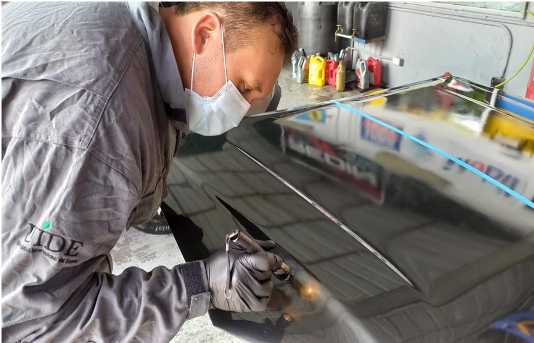
Figura 4.30. Verificación de imperfecciones con la ayuda de una linterna (Autores 2022)
