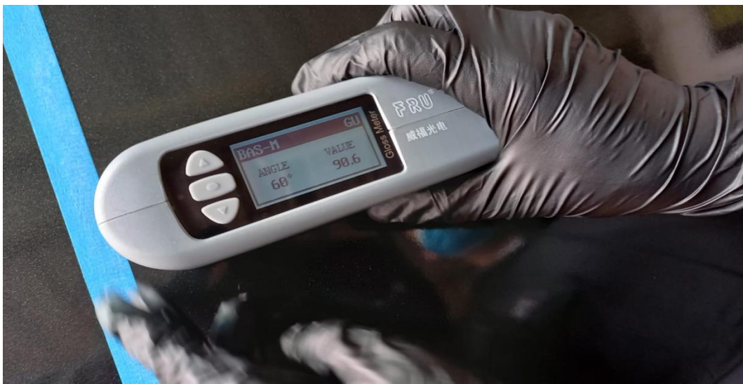
Figura 4.27. Calibración del medidor de brillo
