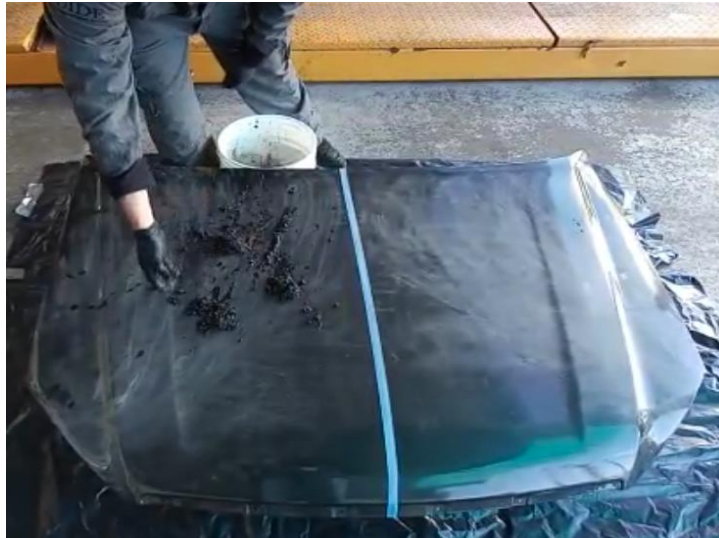
Figura 6.79. Colocación de lodo en lado sin cerámico
