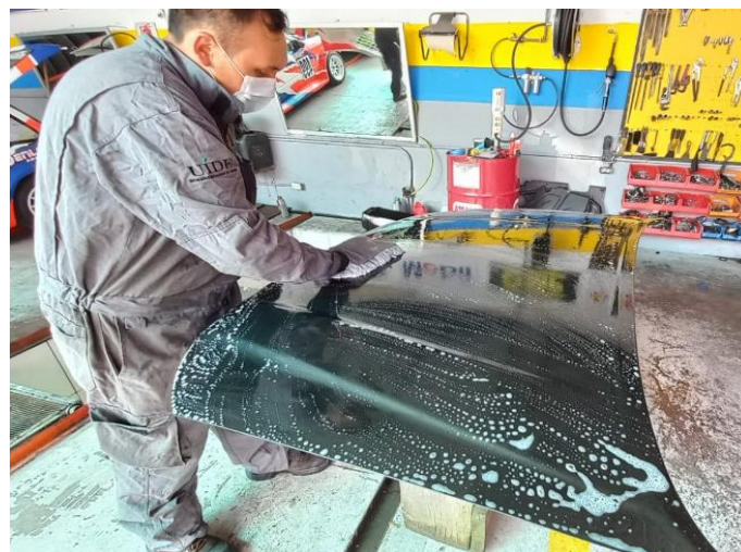
Figura 4.21. Limpieza con shampoo automotriz sobre la superficie
