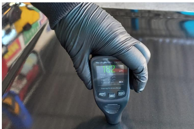
Figura 4.24. Medidor de Espesor (Autores 2022)
