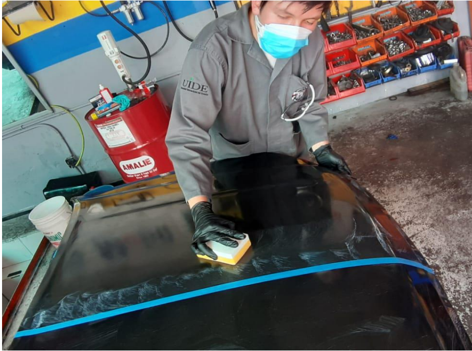
Figura 4.28. Corrección de pintura por secciones (Autores 2022)
