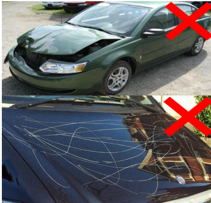
Figura 4.14. Cofre en condiciones no aptas (Parabrisas, 2016) (Lujan, 2019)
