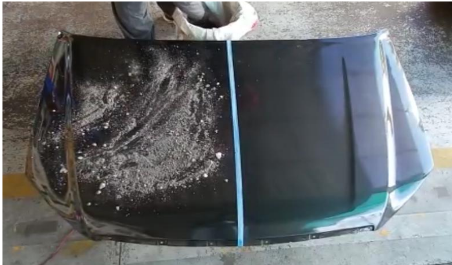
Figura 6.72. Prueba completa en lado sin cerámico
