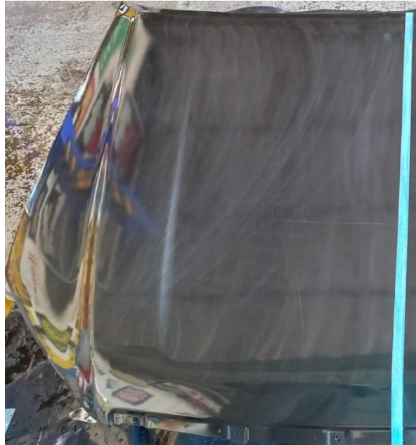
Figura 6.73. Visualización de rayones en sección sin cerámico
