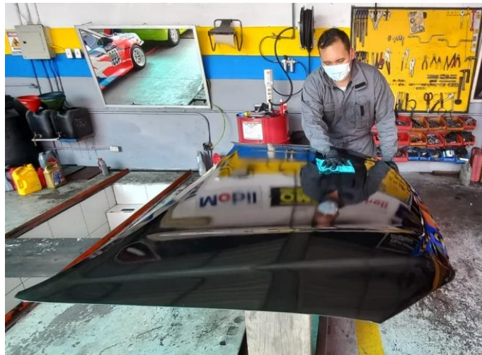
Figura 4.20. Limpieza y secado de la superficie a trabajar
