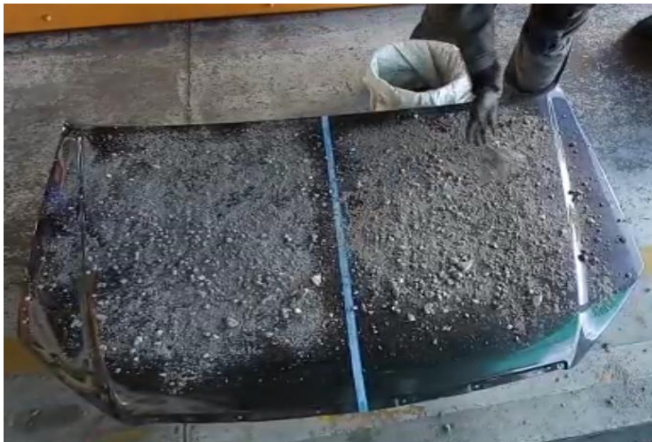
Figura 6.75. Prueba de gravilla completa en lado con cerámico (Autores 2022)
