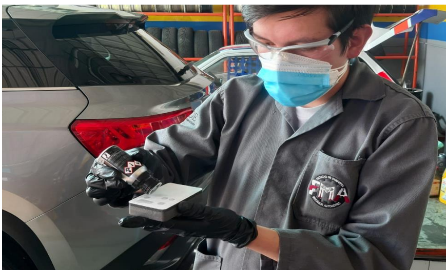
Figura 4.34. Colocación del Tratamiento Cerámico en aplicador
