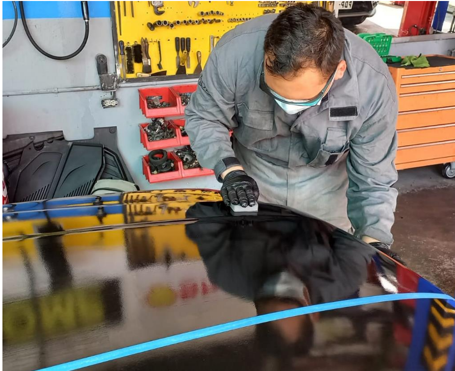
Figura 4.35. Colocación de Tratamiento Cerámico primer recubrimiento
