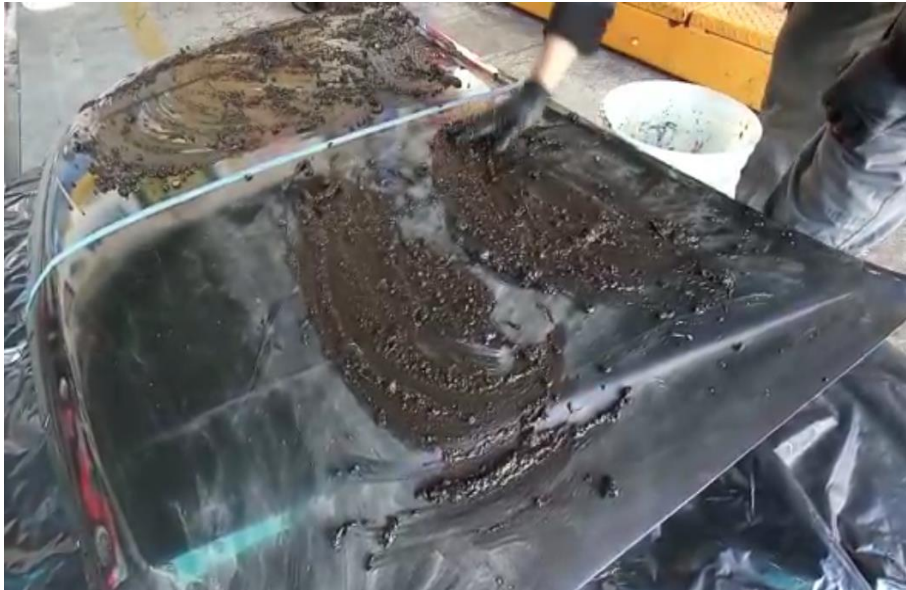
Figura 6.81. Colocación de lodo en lado con cerámico (Autores 2022)
