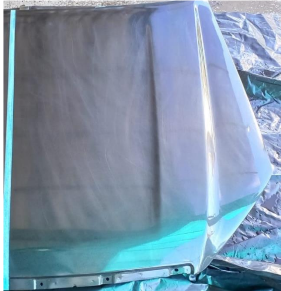
Figura 6.76. Visualización de rayones en sección sin cerámico
