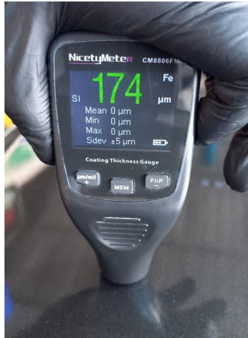
Figura 4.25. Acercamiento a la pantalla del medidor de espesor
