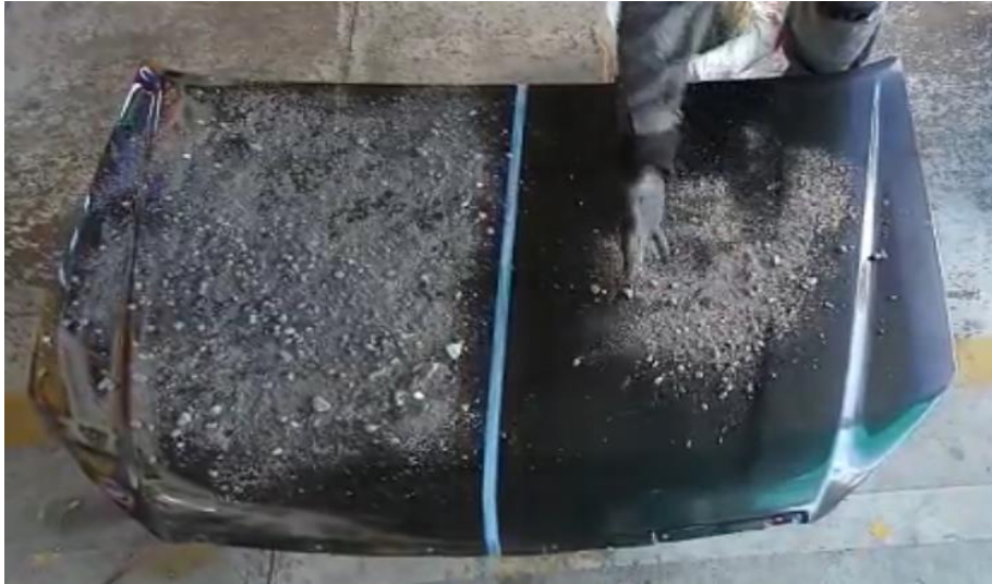
Figura 6.74. Prueba de gravilla en lado con cerámico (Autores 2022)
