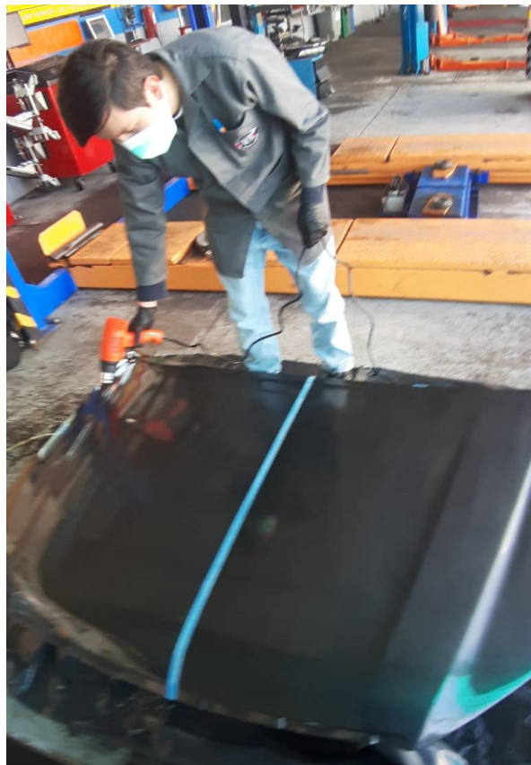
Figura 6.84. Aplicación de calor en la superficie (Autores 2022)
