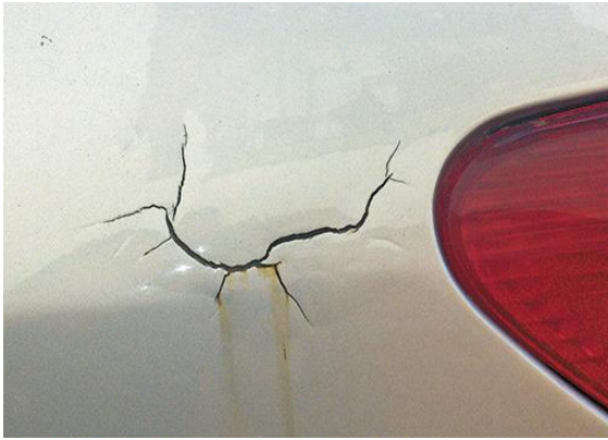
Figura 5.62. Fisura en el vehículo (autofácil, 2020)
