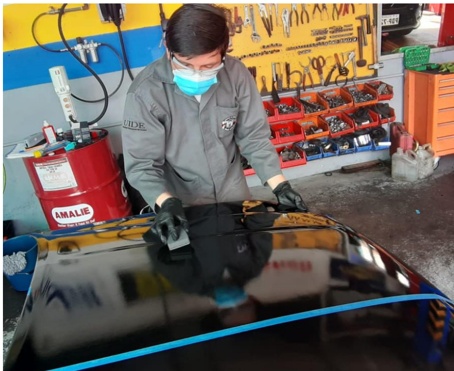
Figura 4.36. Colocación de Tratamiento Cerámico segundo recubrimiento
