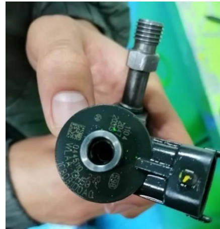
Figura 12. Identificación del código presente en el propio inyector para el diagnóstico
