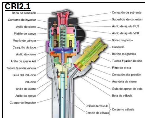
Figura 9. Partes internas del inyector Bosch serie 00445110250
