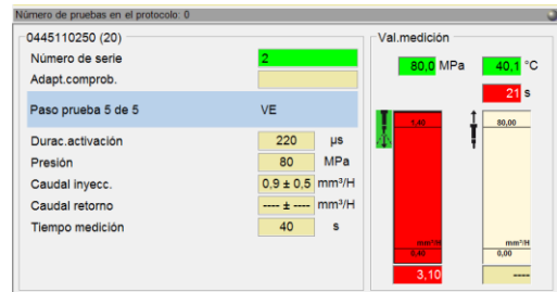
Figura 26. Visualización de la prueba de preinyección VE en el segundo inyector
