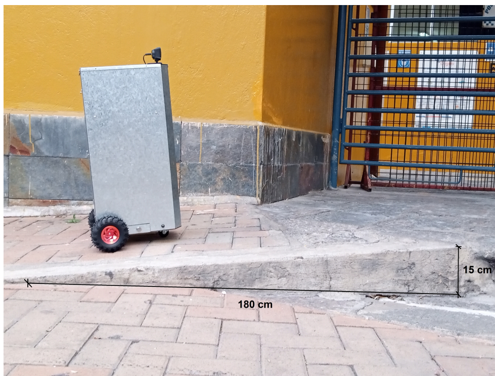
Figura 71. Prueba 1 en rampa para discapacitados
