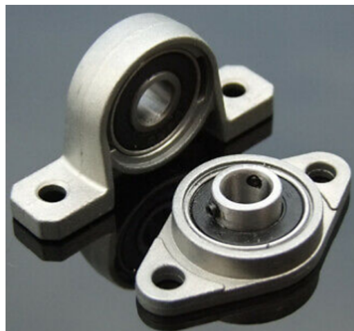
Figura 20. Chumaceras para máquinas CNC de 8 mm diámetro KFL08-001 [11]
