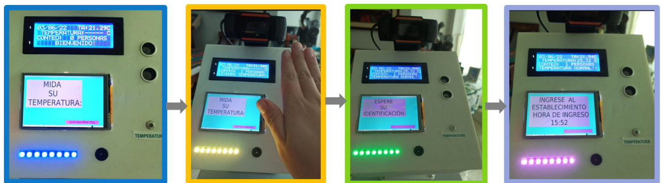
Figura 110: Visualización del sistema de medición de temperatura en varias etapas.
