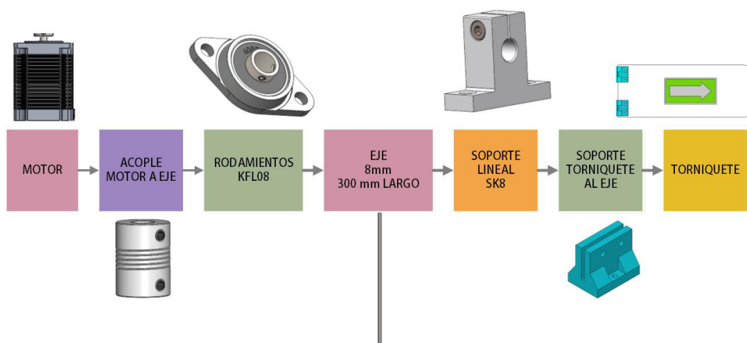
Figura 126: Diagrama de las partes del torniquete de ingreso.
