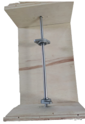
Figura 123: Construcción de la base donde se ubica el eje.
