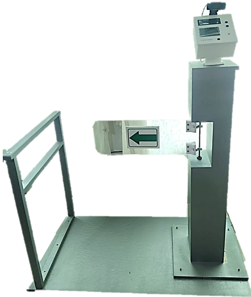
Figura 133: Prototipo del Sistema de ingreso
