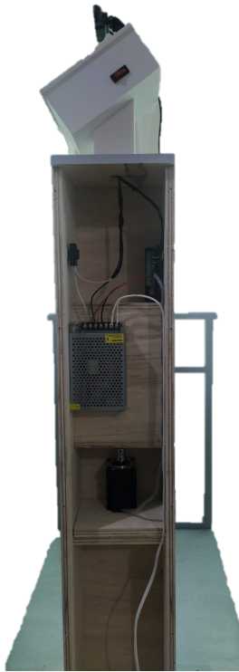
Figura 132: Estructura principal conexiones de motor, driver y fuente de alimentación.
