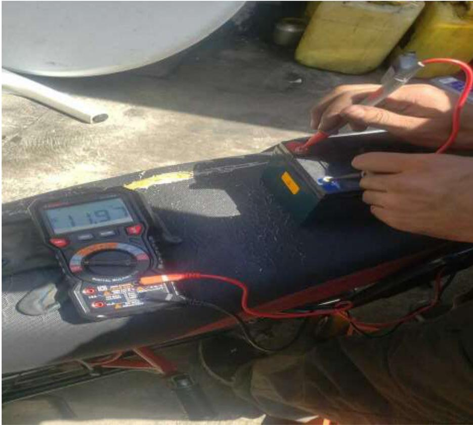
**ANEXO 58.** Voltaje final scooter eléctrico en prueba de temperatura (48 °C)
