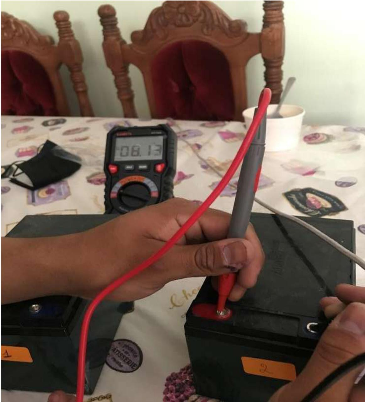
**ANEXO 52.** Voltaje final batería 1 en prueba 1 de temperatura (-6 °C)
