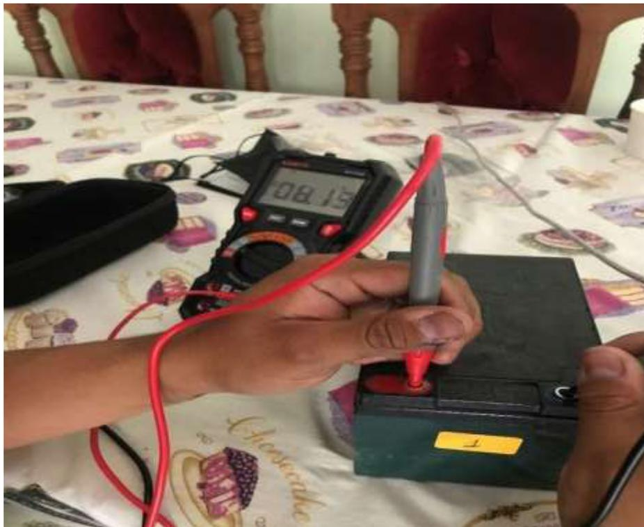
ANEXO 51. Voltaje inicial batería 2 en prueba 1 de temperatura (-6 °C)
