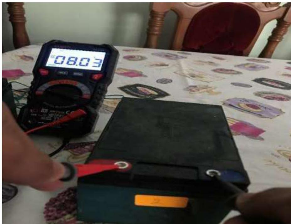
**ANEXO 54.** Voltaje inicial batería 1 en prueba 2 de temperatura (-6 °C)
