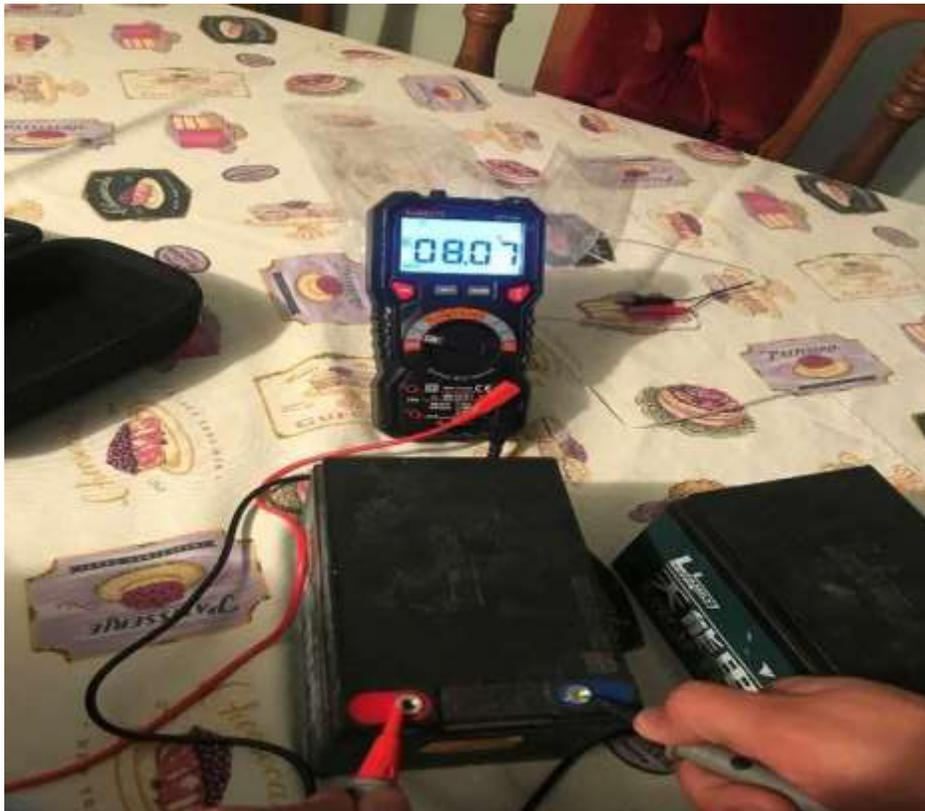
**ANEXO 55.** Voltaje inicial batería 2 en prueba 2 de temperatura (-6 °C)
