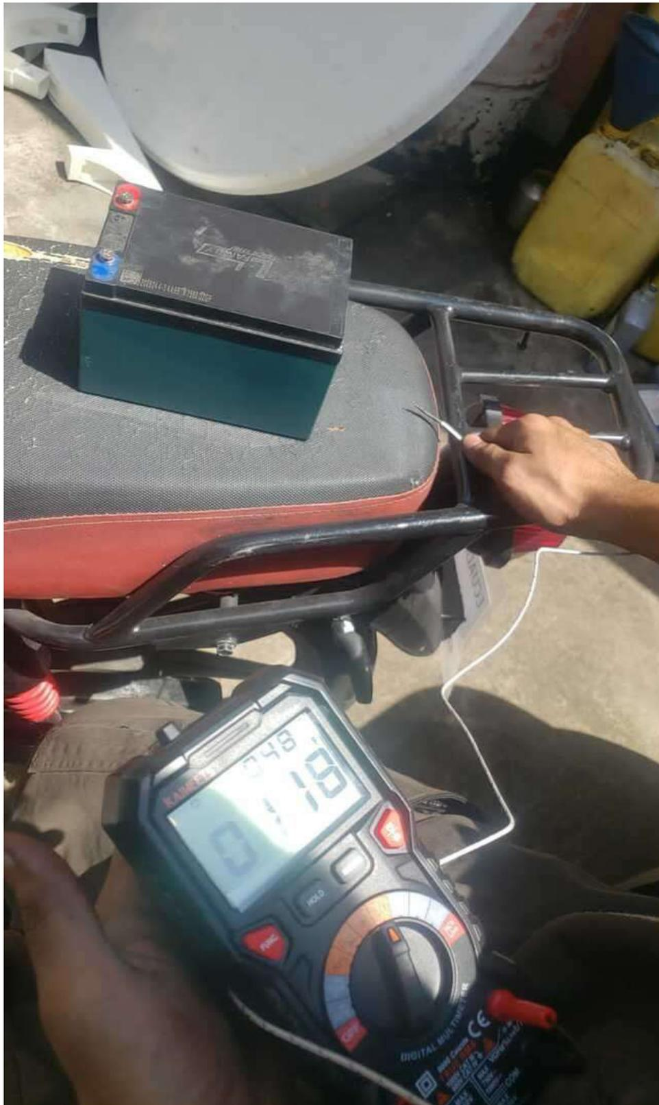
**ANEXO 57.** Voltaje inicial scooter eléctrico en prueba de temperatura (48 °C)
