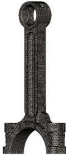
Finalmente se procede al análisis estático, donde como resultados se obtiene Tensión Máxima de 1445 MPa, dando un factor aceptable en base al límite elástico de 305 MPa, observando que la mayor parte del cuerpo se ubica en este límite.
