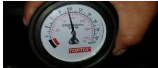
**Figura 6.** Medida de presión del motor J20A
