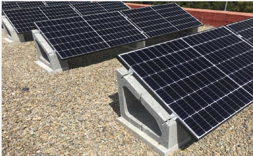
El sistema Solarbloc® permite fijar los módulos solares directamente al soporte sin utilizar estructura metálica. **Los soportes Solarbloc® se fabrican en ocho grados distintos, 3°, 10°, 12°, 15°, 18°, 28°, 30° y 34°.** Debemos elegir la inclinación del soporte más idónea teniendo en cuenta las necesidades de la instalación.
