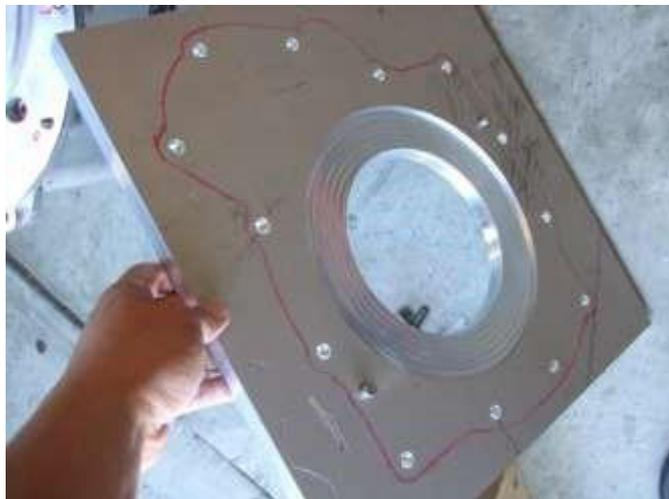
Ejemplo de ejecución de placa para montaje del motor eléctrico en una caja de marchas. En este caso de aluminio de 14 mm.
