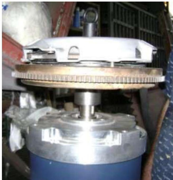
Vista lateral con la placa y disco de embrague instalado.
