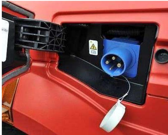
Típica entrada de carga mediante una toma 2 P+T de 16 a 32 amperes. Se instala en la anterior entrada de combustible y se dispondrá también de un cable de 4 m con conectores para la entrada de 120 o 220 V según el cargador.
