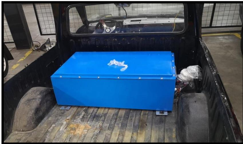
**Figura 4 62** Batería 108V
