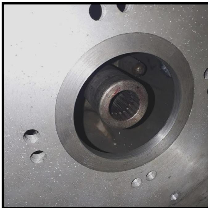
**Figura 4 47** Acople caja-motor instalado en caja
