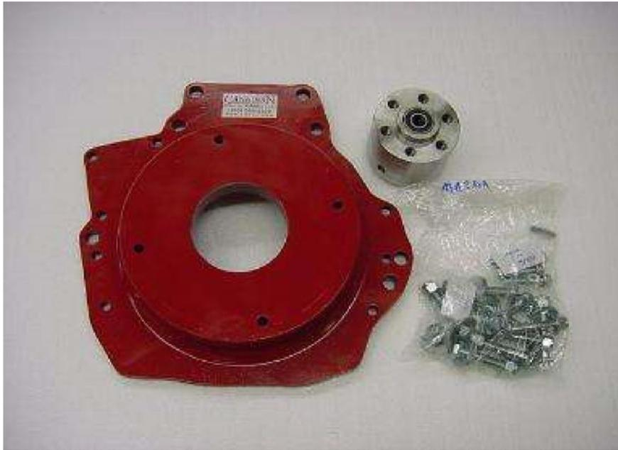
Vista de placa en hierro de 8 mm y acople al volante original donde también queda funcionando el embrague para un ágil cambio de marchas. Nótese el acople en aluminio que va en el eje con chaveta de seguridad del AC 1 y los seis orificios para tornillos que calzan en el volante.
