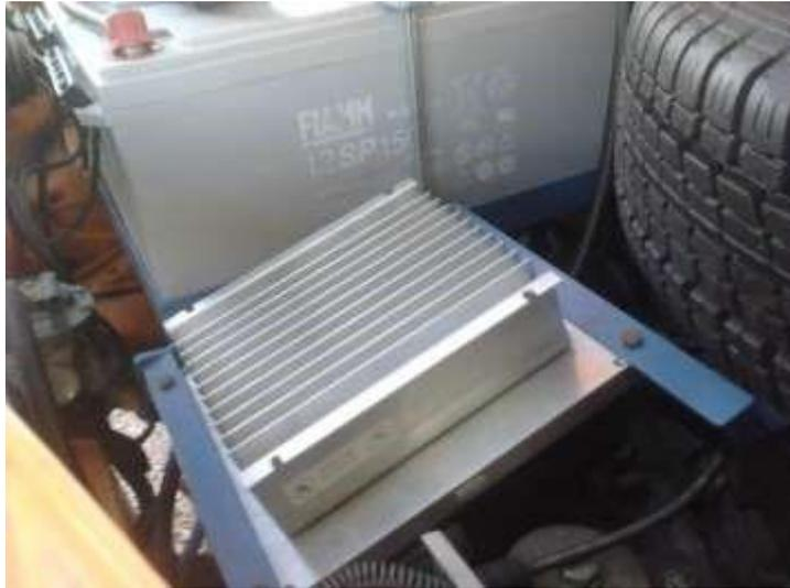
Se deben evitar posiciones del controlador que queden encerradas o no reciban circulación de aire. Este tiene que conducir las altas intensidades de corriente del sistema (hasta 500 Amperes) y estas causan aumentos de temperatura que debe ser disipada. La pantalla digital nos permite ver el dato de temperatura del controlador y esta no debería superar los 85 ° centígrados.
