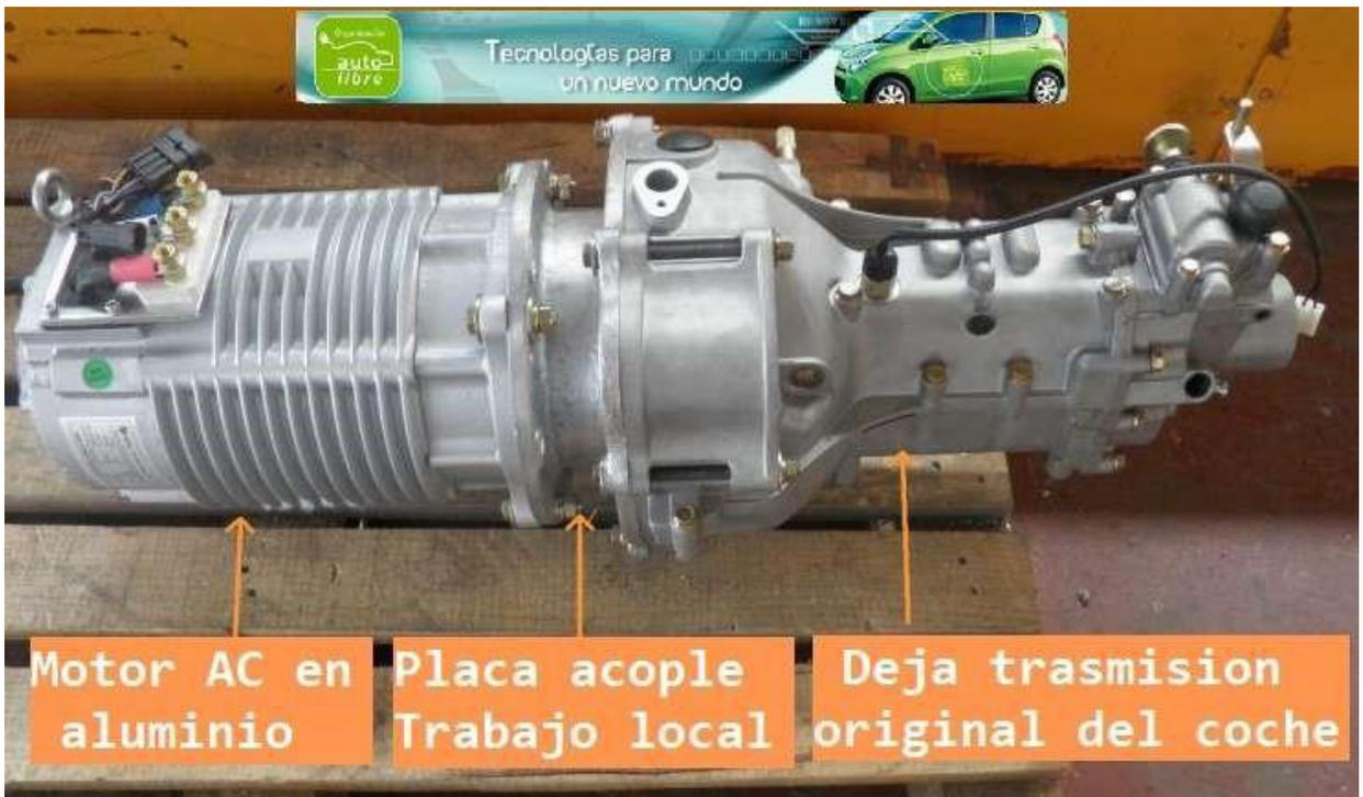
Vista del motor ya instalado en la caja de marchas para tracción trasera.
