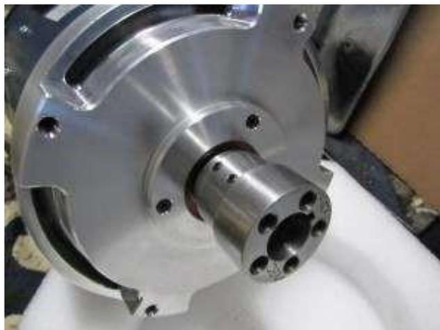
Placa adaptadora y acople listo para conectar el volante. Más abajo, el volante colocado y listo para colocar placa y disco de embrague.
