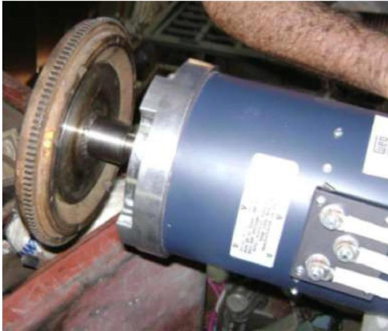
Vista del Motor acoplado mediante un acople soldado al volante. (Recomendamos el acople con tornillos).
