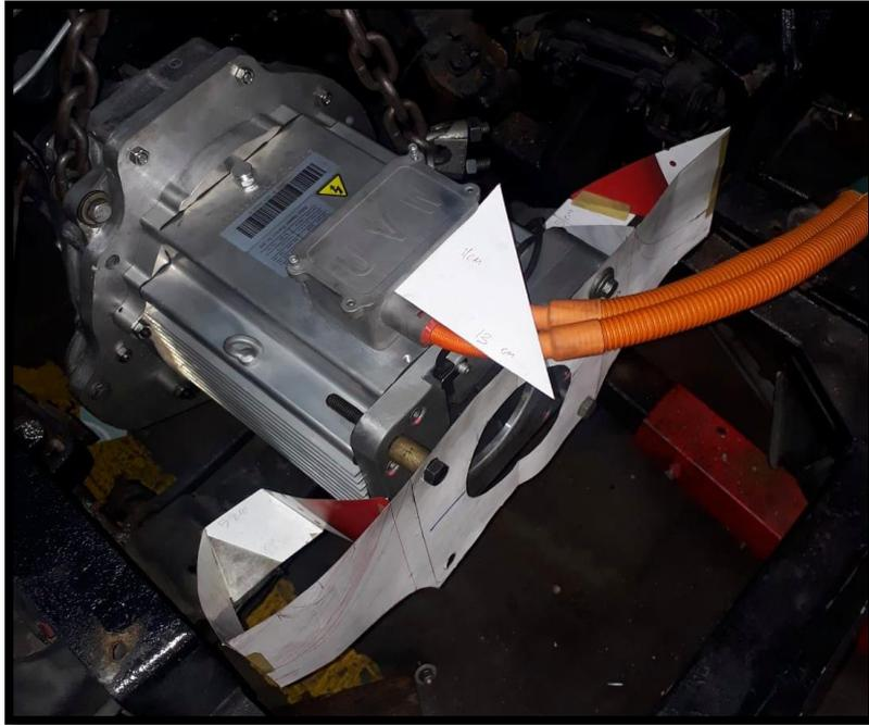
**Figura 4 55** Conjunto caja-motor, modelo base en cartón
