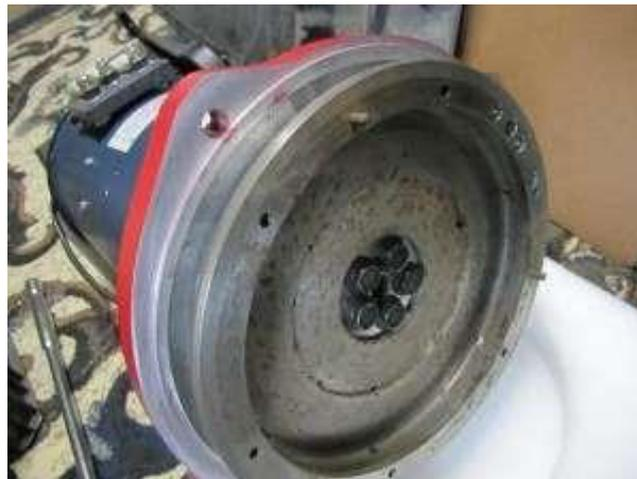
Segundo ejemplo: Vista del AC 1 con su placa de adaptación y el acople listo para calzar el volante.
