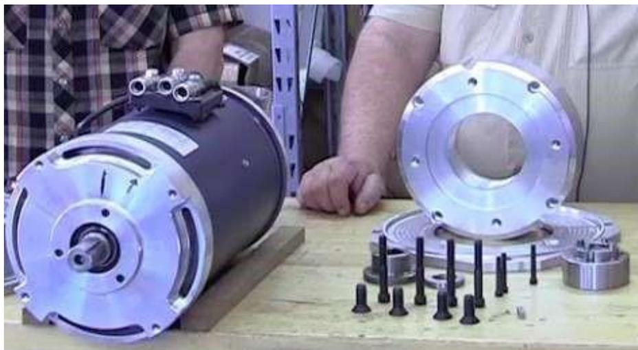
Vista de otro modelo de motor AC 1 con placa de adaptación y acoples al volante de embrague todo en aluminio.
