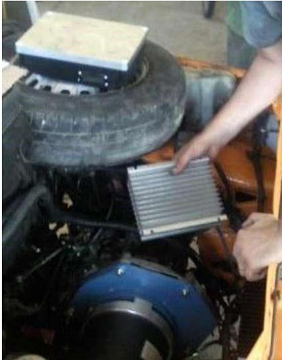
La unión del disipador a la placa de aluminio del controlador se realiza mediante 4 tornillos roscados y pasta térmica entre las superficies planas. Los tornillos solo deben entrar un máximo de 5 mm en la placa del mismo.
