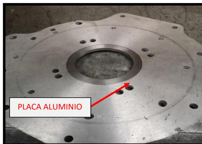
**Figura 4 45** Espaciador caja-motor
