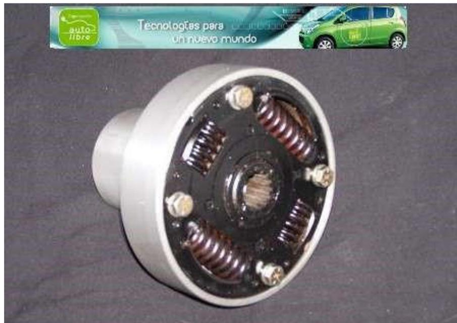
Ejemplo de acople que comunica directamente eje de motor eléctrico con la directa de la caja de marchas y donde se usa el centro del disco de embrague que cuenta con la estría justa para una rápida colocación.
