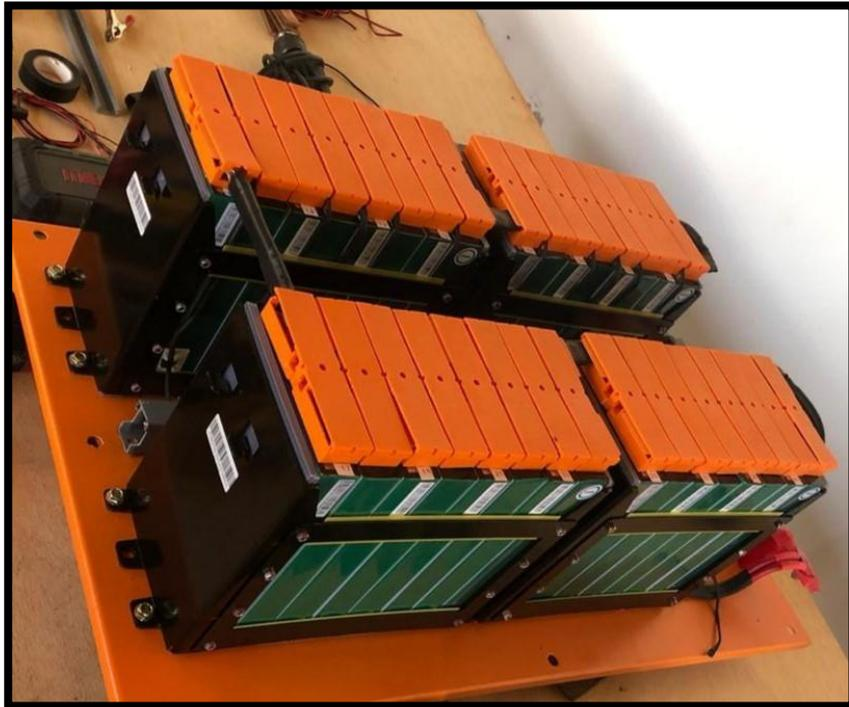
**Figura 4 14** Batería 108V
