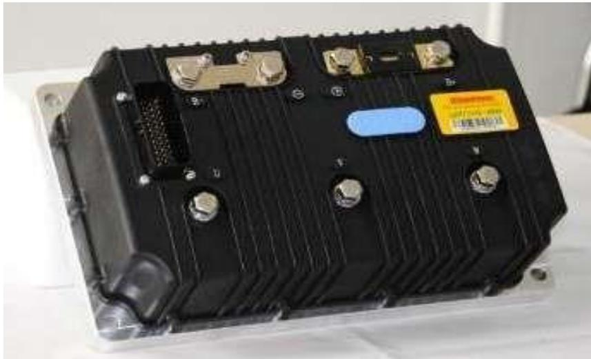
El Enpower a veces ya viene con disipador aleteado de aluminio en la base. En caso de no tener estas se pueden diseñar en forma local.
