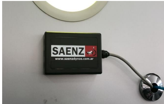
Fig. 3.24. Módulo bypass para motores eléctricos. Fuente: (Saenz, 2016).
