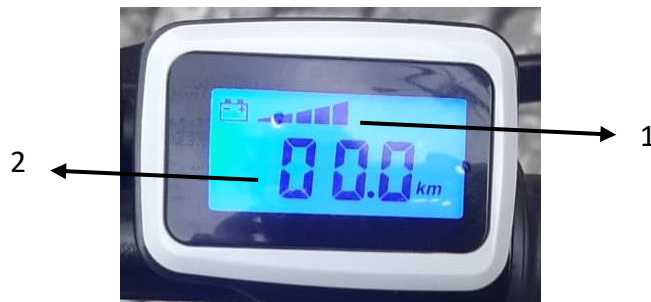
Fig. 5.4. Funciones pantalla LED. Fuente: Autores.
