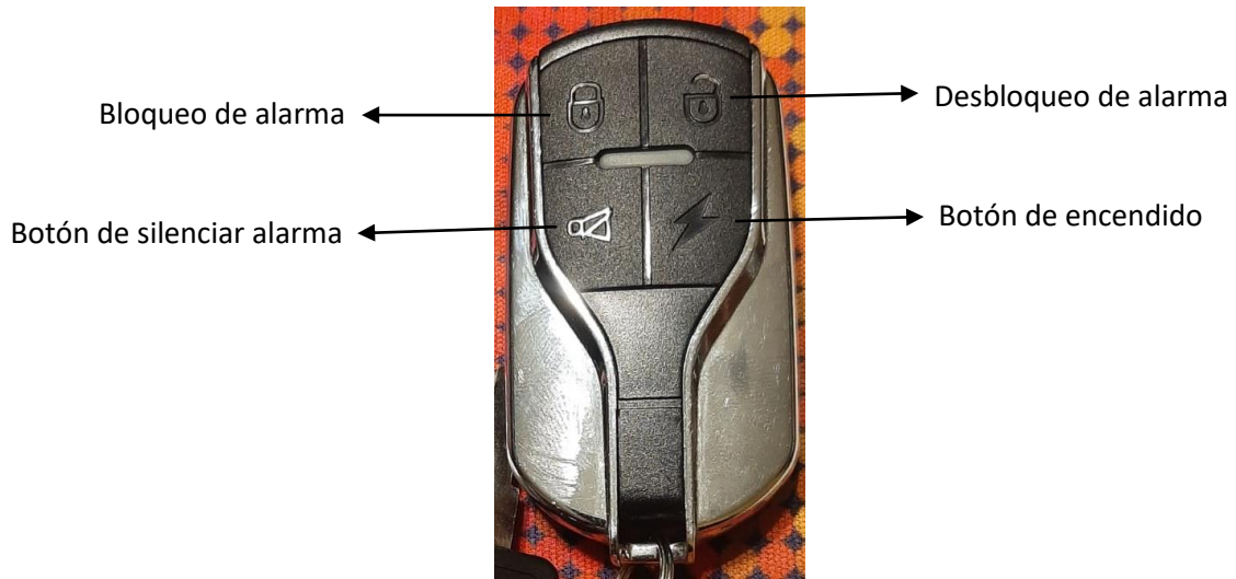
Fig. 5.3. Partes de control de encendido. Fuente: Autores.
