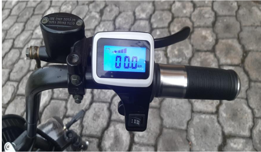
Fig. 3.17. Panel de control LCD y selector de marchas. Fuente: Autores.
