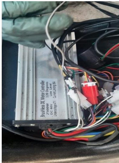
Fig. 3.15. Módulo controlador del motor eléctrico. Fuente: Autores.
