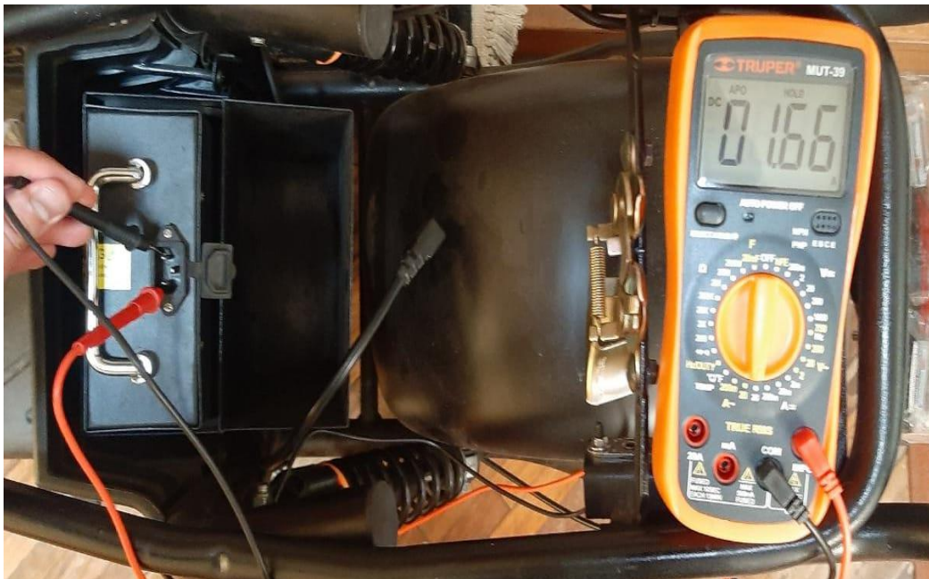
Fig. 5.10. Amperaje posterior a prueba Ruta La Carolina (1 ocupante). Fuente: Autores.
