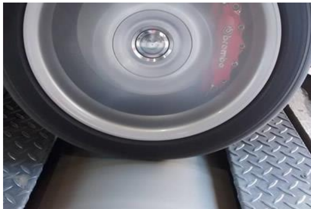
Fig. 3.23. Rodillo de inercia. Fuente: (Saenz, 2016)
