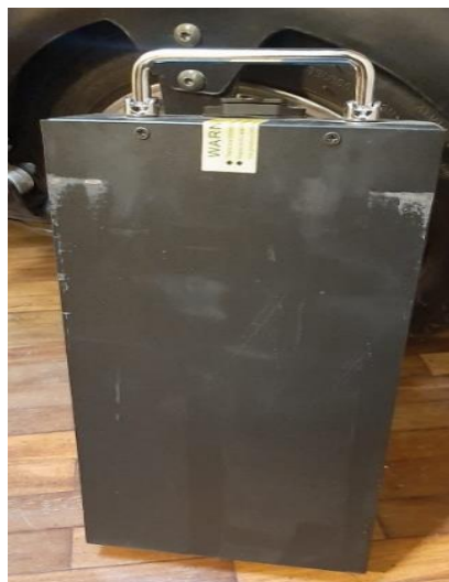
Fig. 3.14. Batería de Ion Litio 60 V / 20 Ah. Fuente: Autores.
