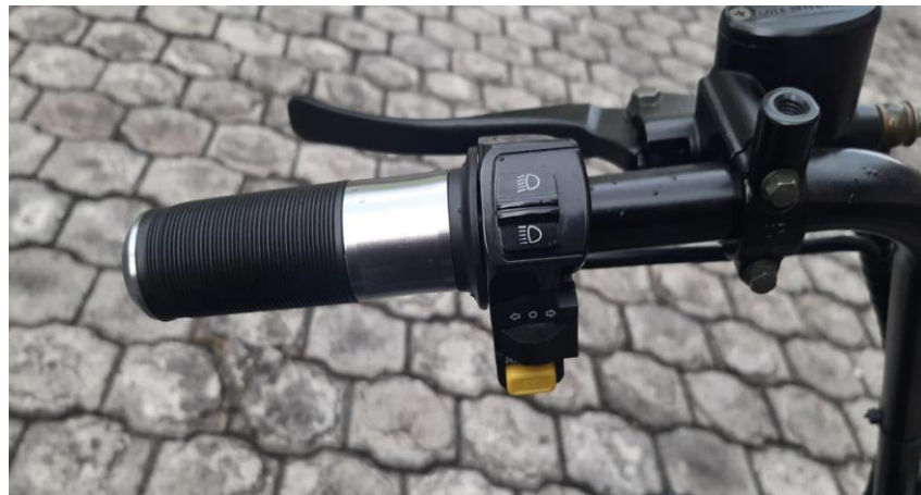
Fig. 3.18. Control de luces y bocina. Fuente: Autores.
