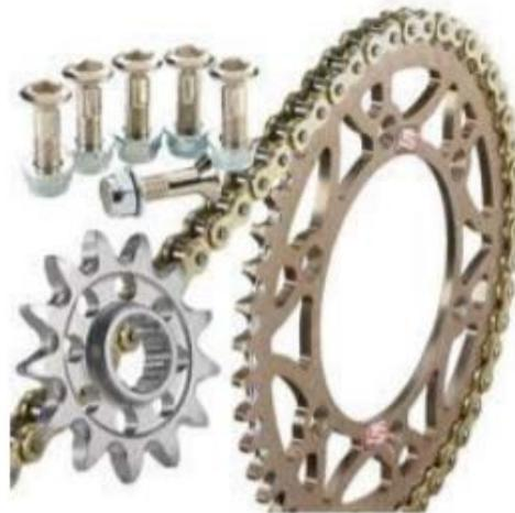
Los sistemas de transmisión por cadena se emplean para transmitir movimiento entre dos ejes paralelos que se encuentran alejados entre sí.
