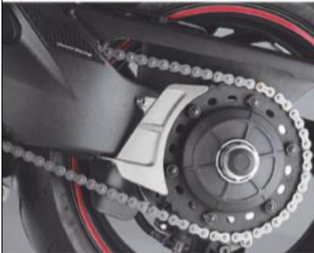
**Potencia.** La potencia generada durante el proceso de combustión dentro del motor tiene que llegar a la rueda trasera para poder moverla. Esta función la cumple una serie de mecanismos cuya última etapa la conforman la cadena y la corona, como vemos en el ejemplo de esta Honda CB 1000 R.
