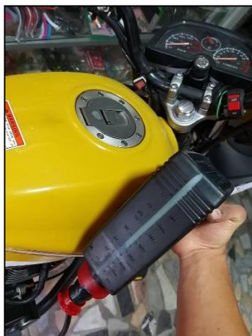
**Figura 8.** Tanque de gasolina y probeta graduada
