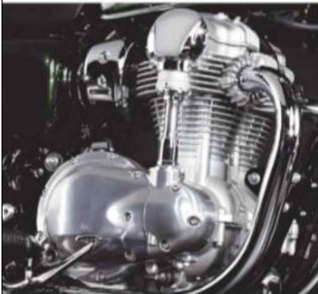
**Aire del exterior.** Los motores que utilizan aire del exterior para su refrigeración, como es el caso de esta Kawasaki W 800, suelen tener canaletas pronunciadas para aumentar su superficie, y así mejorar el intercambio de calor entre el motor y el aire.
