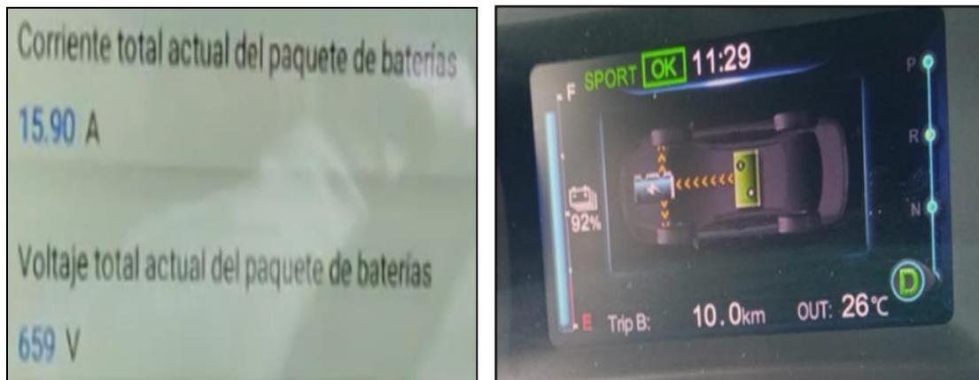
Se determina el recorrido del vehículo por Km: El vehículo recorre un aproximado de 336 Km, con 6 Kw, porque es la corriente total por el voltaje total.
