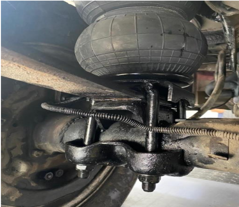
Figura 37 Acople de Bolsa de Aire en Base de Suspensión Inferior
