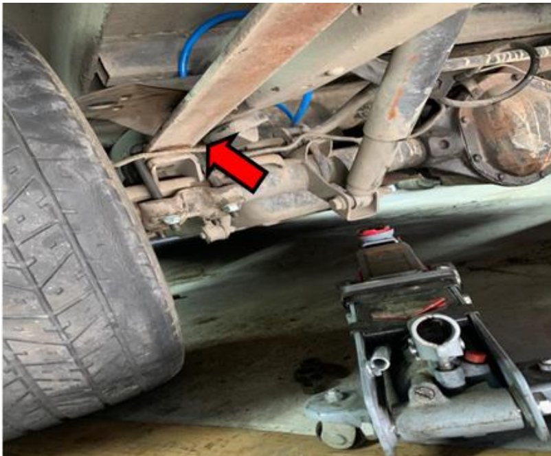
Figura 34 Montaje de Muelle de Suspensión Posterior Modificado
