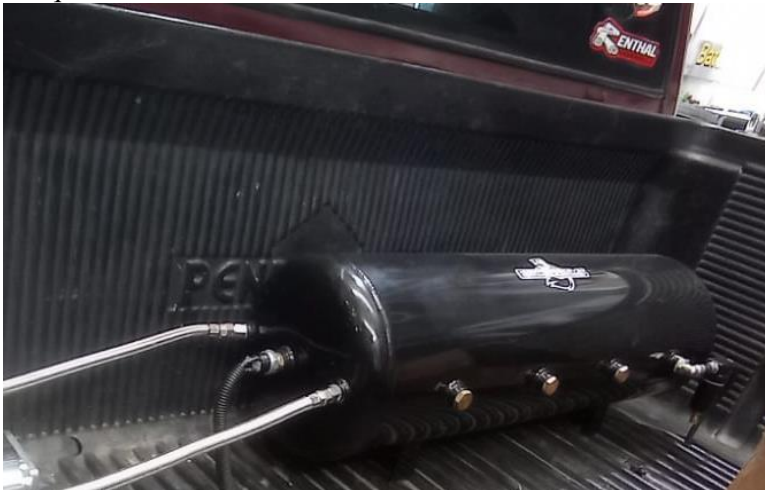
Figura 19 Tanque de 9 litros
