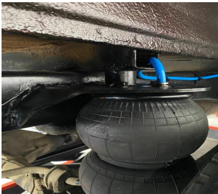
Figura 36 Acople de Bolsa de Aire en Base de Suspensión Superior
