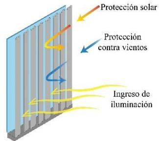
La longitud del alero de la cubierta no es suficiente para proteger al ventanal de los rayos solares, la implementación de este elemento en la caja de gradas de forma vertical inclinadas a 45°, por la orientación hacia el oeste, son de aluminio dado que este material es resistente a las inclemencias del clima y además protege a la superficie vidriada de cualquier accidente. Entre las lamas existe una separación para el ingreso de la luz hacia el interior.
