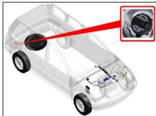
Figura 19. Plug del combustible en el automóvil. Adaptada de Estudio del sistema GLP como combustible alternativo de uso en vehículos automotrices. Barrera (2012).
