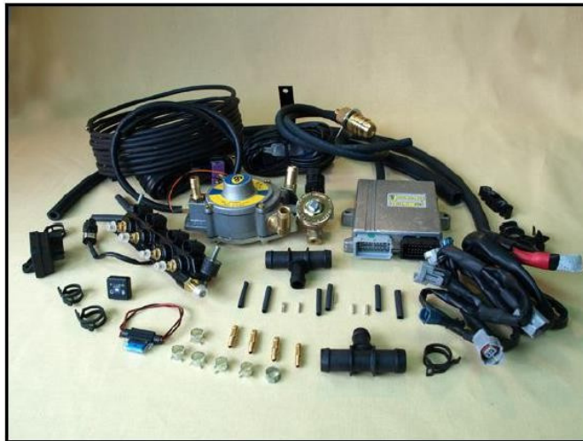
Figura 5. Sistema GLP. Adaptada de Estudio del sistema GLP como combustible alternativo de uso en vehículos automotrices. Barrera (2012).
