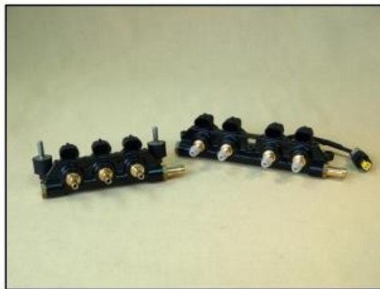
Figura 13. Inyectores. Adaptada de Estudio del sistema GLP como combustible alternativo de uso en vehículos automotrices. Barrera (2012).
