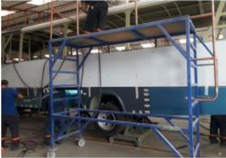
Figura 9: Forro de estructura con fibra de vidrio y planchas de aluminio
