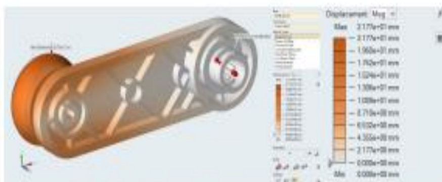
Figura 52 Deformación en la manija original a la carga de 70kg
