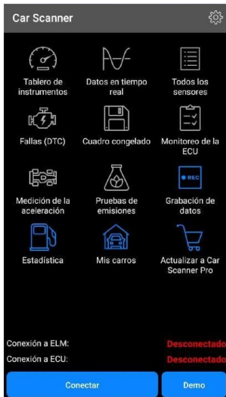
Figura 3.5. Aplicación utilizada en la registro y lectura en tiempo real de los parámetros de la ECU.
