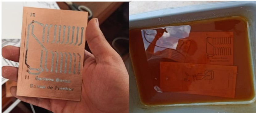
Figura 3.51. Fijación y quema en ácido de prototipo de placa de actuadores Morán. 2022.
