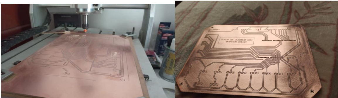
Figura 3.49. Fabricación de placa de sensores en máquina CNC Morán. 2022.
