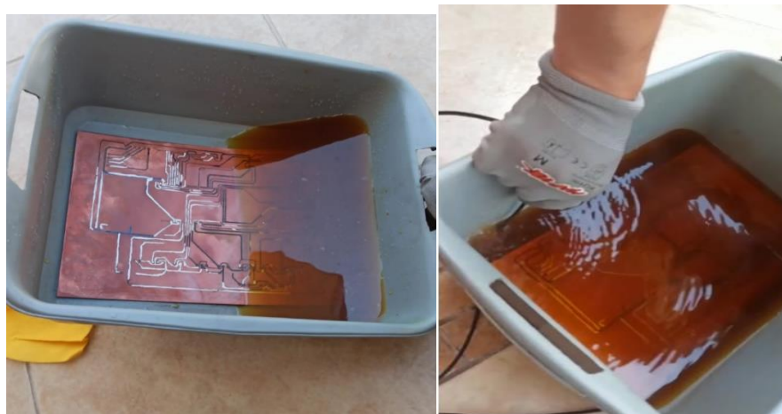
Figura 3.43. Proceso de quema de la baquelita de placa de sensores Morán. 2022.
