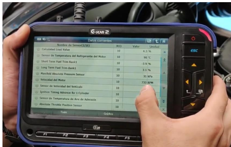
Figura 4.3. Obtención de información del vehículo con escáner G-Scan2 Morán. 2022.
