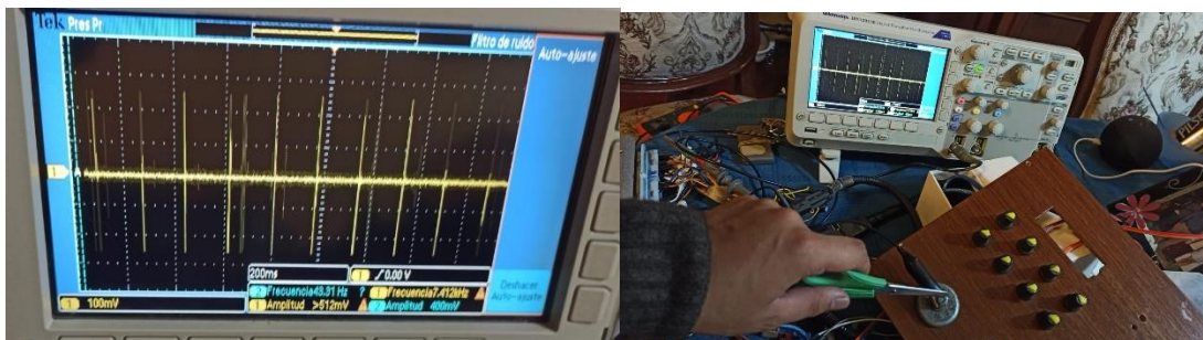
Figura 4.14. Captación de la señal producida por el sensor KS Morán. 2022.
