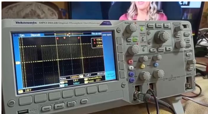
Figura 4.11. Medición de la forma y frecuencia de la señal CKP Morán. 2022.
