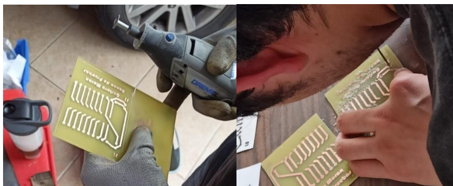
Figura 3.52. Perforación de orificios y acabado de detalles en prototipo de placa de actuadores Morán. 2022.
