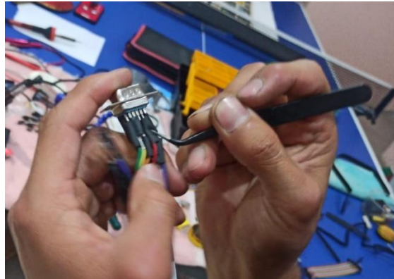
Figura 3.57. Fijación de cinta termo ajustable para aislar las soldaduras Morán. 2022.
