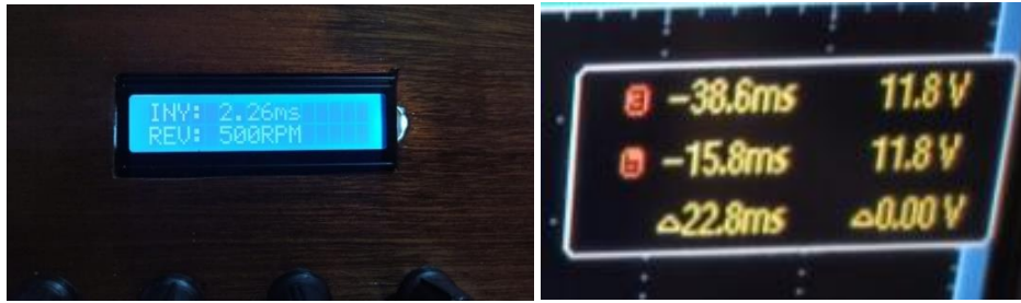
Figura 4.22. Correlación entre la lectura de ancho de pulso del banco de pruebas y el osciloscopio Morán, 2022.
