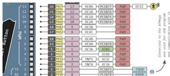
Figura 3.18. Configuración del registro TCCR3C y asignación de pin de escritura del timer 3 Atmel, 2019.
