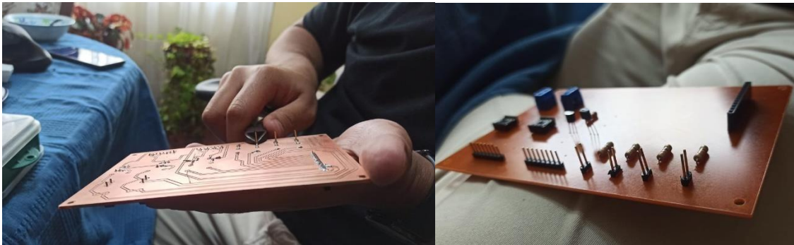
Figura 3.54. Soldadura de elementos en placa de actuadores Morán. 2022.
