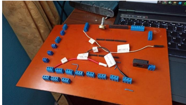
Figura 3.48. Primer prototipo de placa de sensores para pruebas Morán. 2022.
