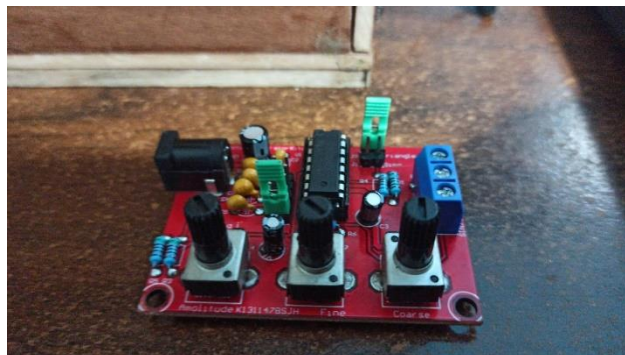
Figura 3.26. Módulo XR2206 generador de señales sinusoidales Morán, 2022.
