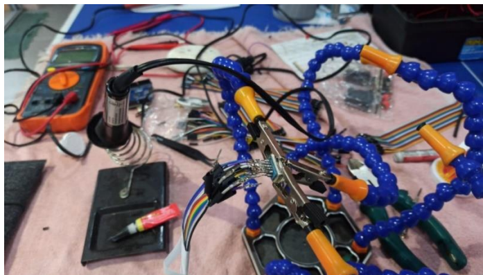
Figura 3.56. Soldadura de cables en boquillas de cada pin del conector Morán, 2022.
