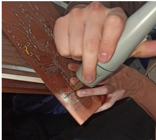
Figura 3.47. Perforación de orificios en la placa de sensores Morán. 2022.
