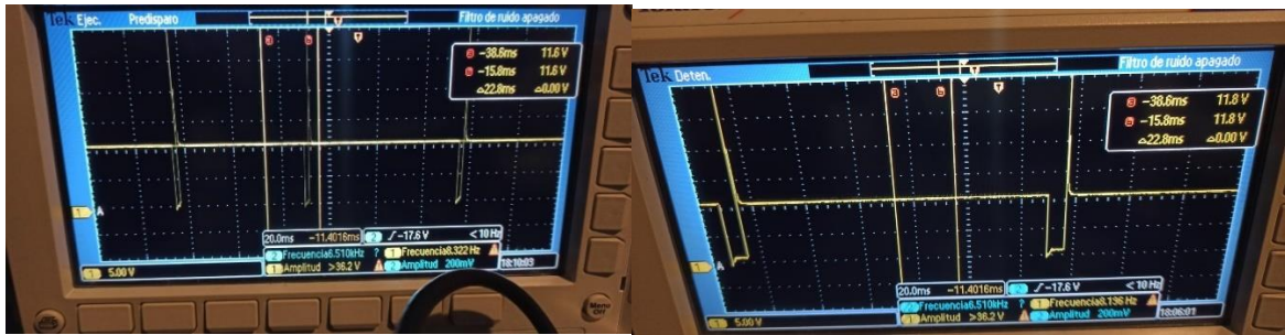
Figura 4.24. Cambio producido en el ancho de pulso por modificación de señal MAP Morán, 2022.
