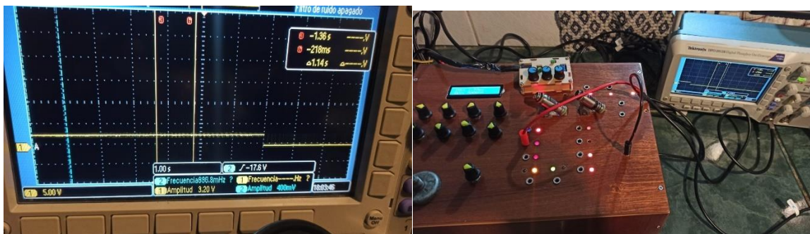
Figura 4.19. Pruebas realizadas en el osciloscopio para verificar la activación de actuadores Morán. 2022.
