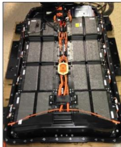
Figura 3. Paquete de baterías del KIA SOUL.
