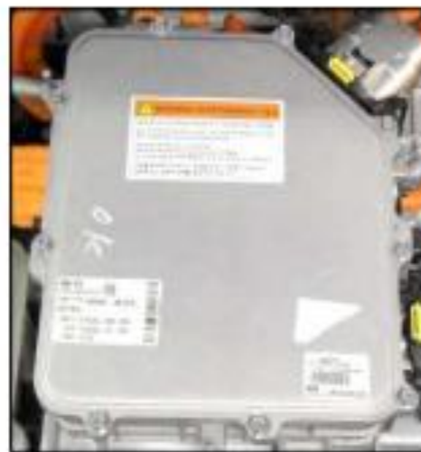
Figura 2.28. Bloque de conexiones de alto voltaje del vehículo Kia Soul Ev.
