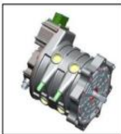
Figura 2.32. Motor eléctrico del vehículo Kia Soul.
