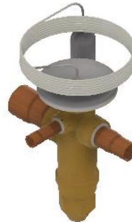
Figura 5. Modelo de la Válvula de Expansión
