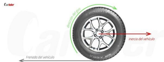
Imagen 6: Fuerza de frenado en los neumáticos Fuente: [10]
