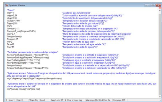
Figura 6.4.2.1.1: Captura de pantalla del cálculo de caudales de propano y agua necesarios para mantener las condiciones de operación preestablecidas
