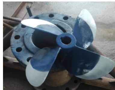
Figura 5: Elice de 4 aspas y 23.7 pulgadas construida para la embarcación.
