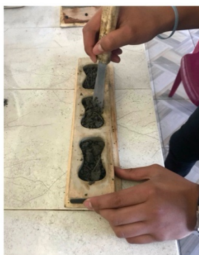
4. MOLDEO DE PROBETAS
