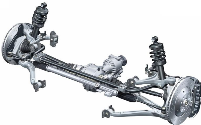
Figura 2-20. Suspensión de paralelogramo deformable instalada en el Audi R8
