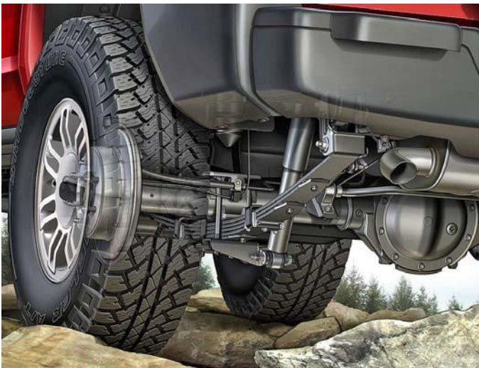
Figura 2-5. Ballesta instalada en el eje trasero de un Humer H2
