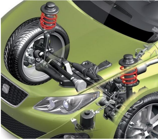
Figura 3.1. Suspensión McPherson. Seat Ibiza
