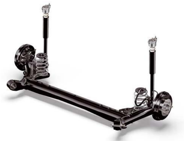
Figura 2-15. Suspensión semirrígida instalada en un Mazda 2
