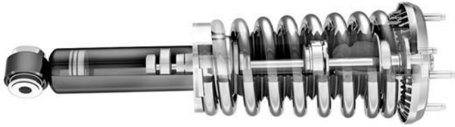
Figura 2-7. Detalle de un amortiguador “monotubo” de un Jaguar XF
