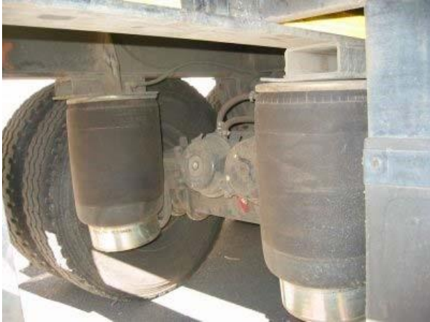
Figura 2-6. Cojines neumáticos, eje posterior de un vehículo pesado.
