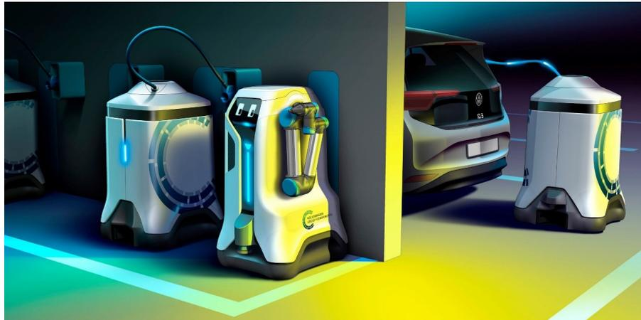
**Figura 12.** Robot de Volkswagen para cargar vehículos eléctricos
