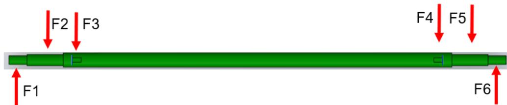
**Figura 28.** Eje de estructura hexagonal con cambios de sección
