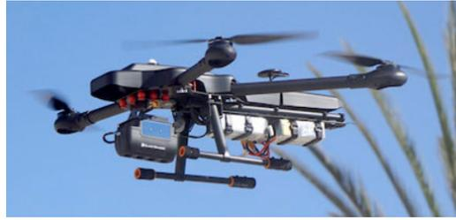
**Figura 9.** Dron de inspección AD2 [9]
