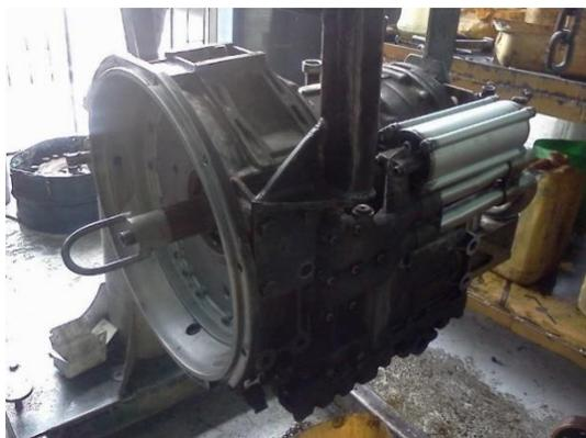
**3.11.4 Desmontaje de la Tapa de Cierre de la Caja**
