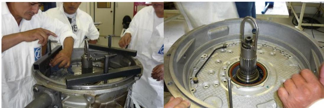
**3.11.5 Desmontaje del Cárter de Aceite**
