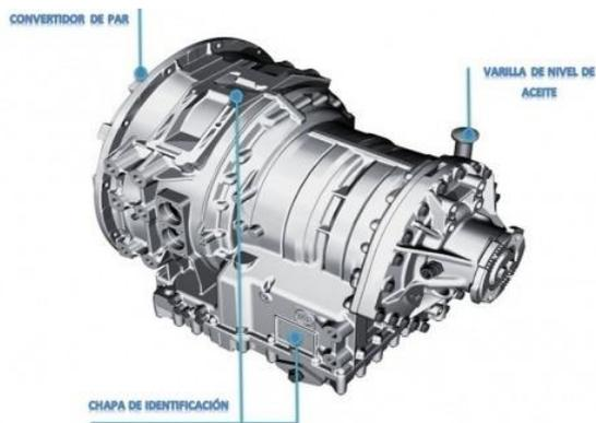
Fuente: Adaptado de ZF ECOMAT, de AUTOSUR de levante, s.f.
