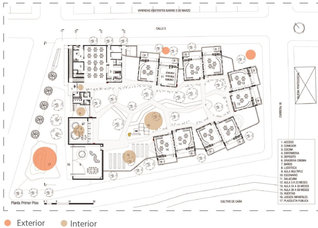
Imagen 44. Planta primer nivel – Espacios de uso común
