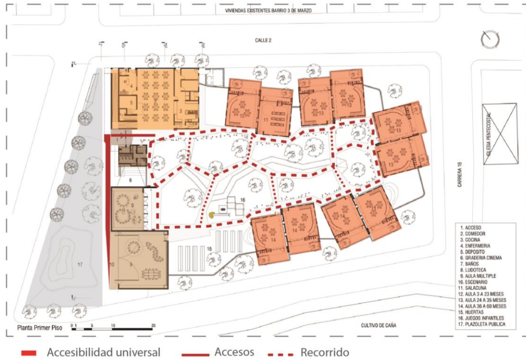
Imagen 43. Planta primer nivel - Circulación
