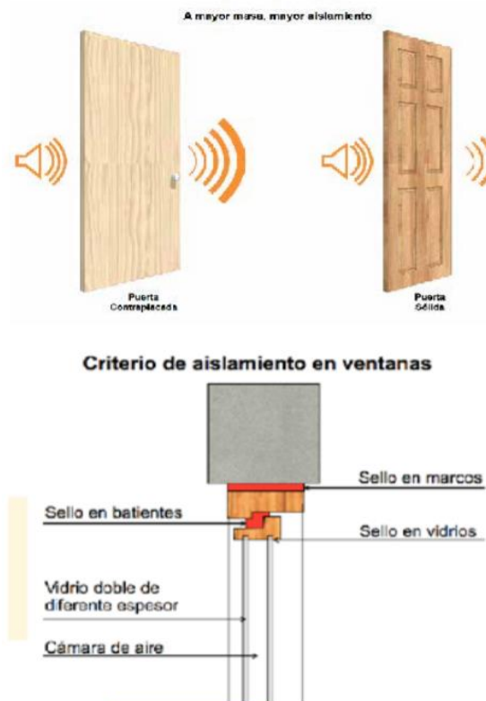
Imagen 32. Aislamiento acústico en puertas y ventanas
