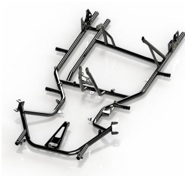
De su comportamiento estructural dependerá sin duda el control de su trayectoria durante su conducción y proporcionando un gran porcentaje en el factor de integridad estructural lo que hace que el vehículo no colapse bajo demasiadas cargas de tensión que son generadas por aceleraciones, desplazamiento por curvas, momentos de frenado o
