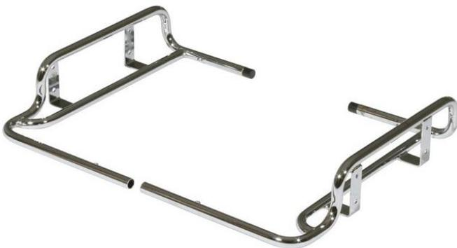
En el caso de las barras laterales cumplen la función de servir de soporte a los protectores laterales y con este conjunto permiten cuidar la integridad del piloto en el caso de una colisión, así mismo en este conjunto se tiene una pequeña barra de torsión, como se muestra en la figura 10, que cumple la función de generar mayor rigidez al kart y suele estar colocada
