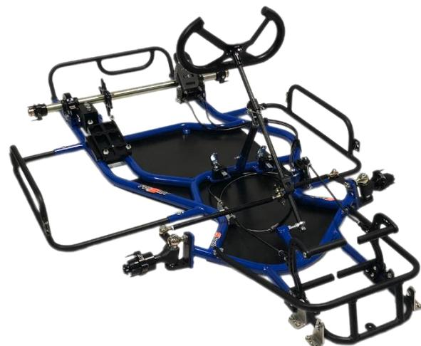
Los chasis denominados Straight, la butaca del conductor se coloca en el centro del kart y son utilizados para carreras de Sprint, como se muestra en la siguiente figura 36.
