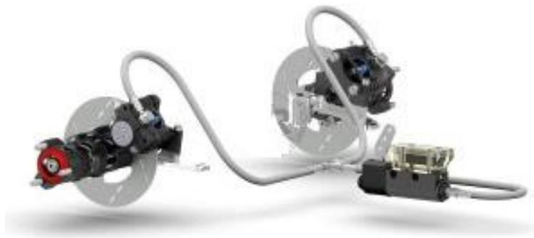
Existen algunos tipos de estos sistemas y no todos los karts poseen frenado a todas las ruedas, pueden estos contar con frenos a un solo disco directo al eje de trasero del kart o de tres puntos que serían distribuidos de la siguiente manera, un freno al eje trasero y un freno a cada una de las ruedas delanteras.
