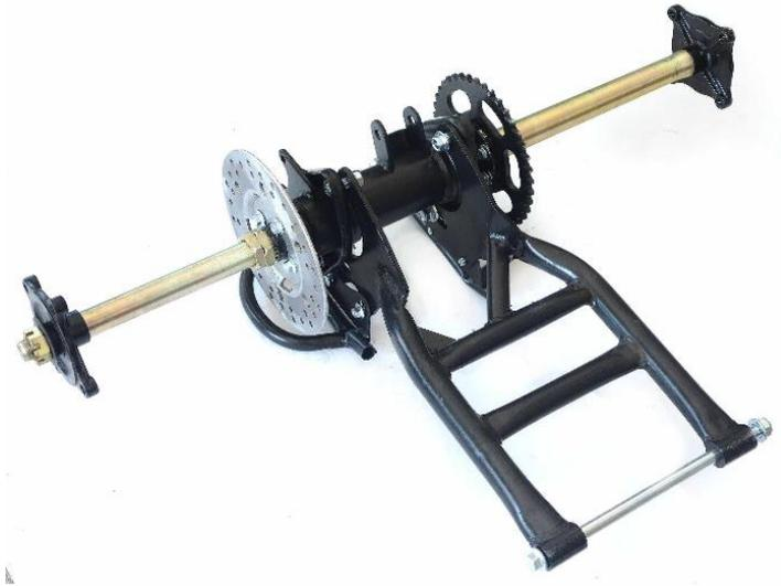
En lo concerniente a los rodamientos de apoyo que soportan a todo el sistema de transmisión como se muestra en la figura 29, permitiendo de esta manera que gire libremente, estos se encuentran anclados al bastidor y suelen estar elaborados de materiales duraderos y otra de sus funciones es la de aislar vibraciones que se soportaría el chasis ya en competencia.
