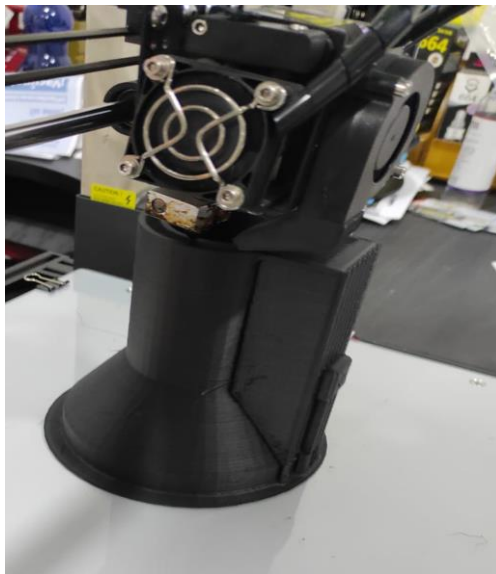
Figura 24. Proceso de impresión 3D del tubo principal amortiguador. Fuente: Salazar, (2021)
