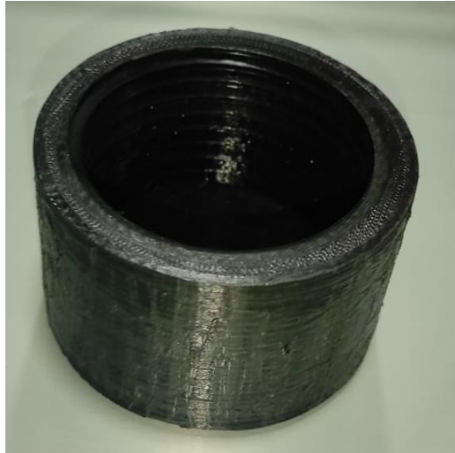
Figura 26. Cubierta inferior roscada impresa en 3D. Fuente: Salazar, (2021)
