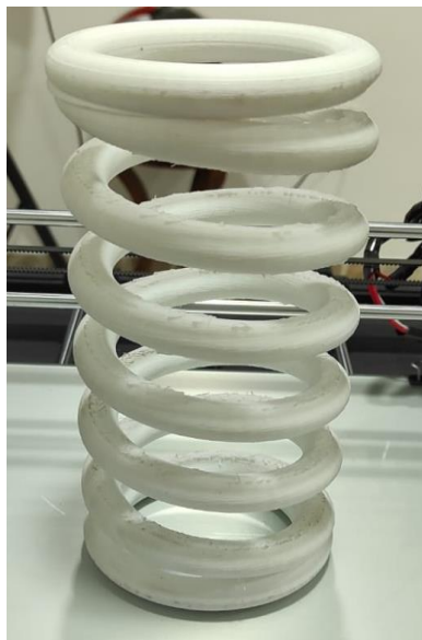
Figura 29. Resorte de compresión impreso en 3D. Fuente: Salazar, (2021)
