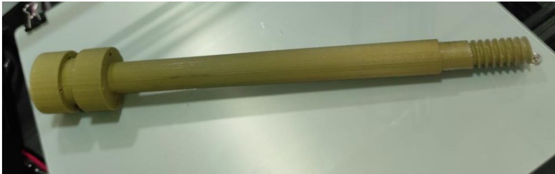
Figura 31. Eje de amortiguador impreso en 3D. Fuente: Salazar, (2021)
