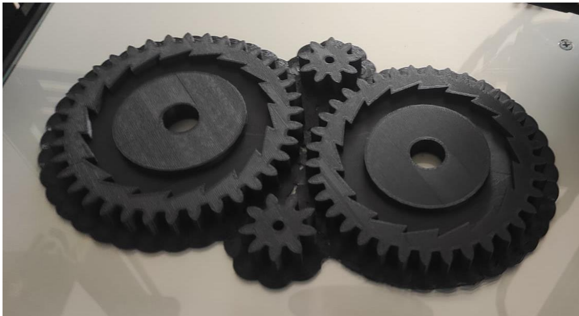
Figura 45. Piñones conducidos impresos en 3D. Fuente: Salazar, (2021).
