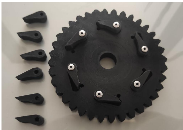
Figura 59. Gatillos de retención alojados en el piñón conductor. Fuente: Salazar, (2021)
