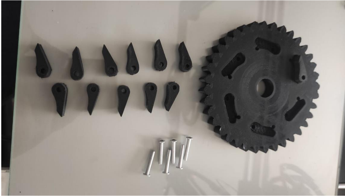
Figura 46. Piñón conductor y gatillos de retención impresos en 3D. Fuente: Salazar, (2021)
