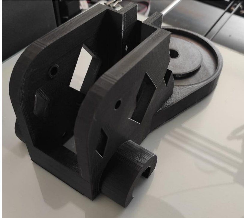
Figura 56. Cubierta superior modificada impresa en 3D vista I. Fuente: Salazar, (2021)
