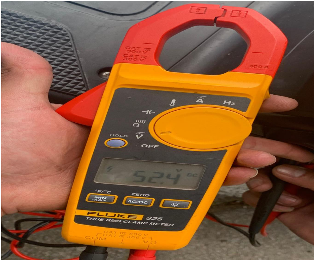
ANEXO 67. Voltaje Inicial Ruta Valle de los Chillos – Pendiente Positiva Scooter Eléctrico 500W
