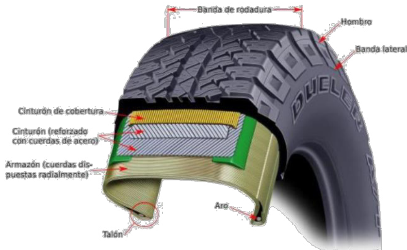
Figura 4. Partes de un neumático típico.
