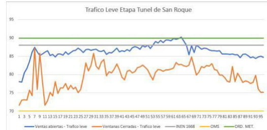
Gráfico 13. Medición de db en la trayectoria del túnel de San Roque
