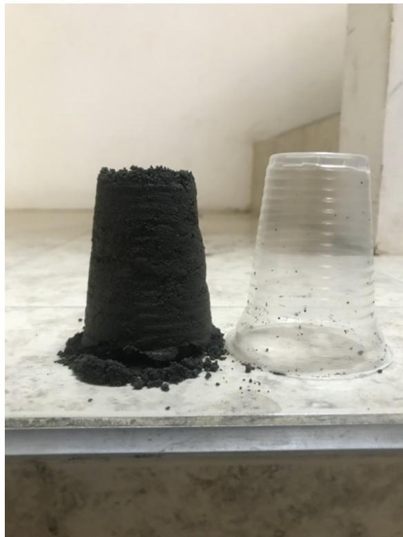
*Nota:* Adaptado de Tratado de construcción con tierra. Este experimento demuestra como las partículas mezcladas toman la cohesión adecuada por *Houben H, et al, (1987)*
