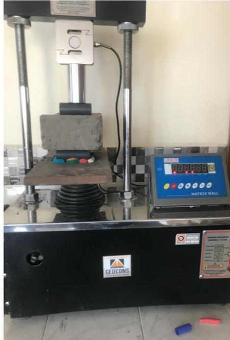
*Nota:* Adaptado de Trabajo de Fin de Titulación, se coloca plastilina para inmovilizar los apoyos y facilitar el proceso por Torres (2021)
