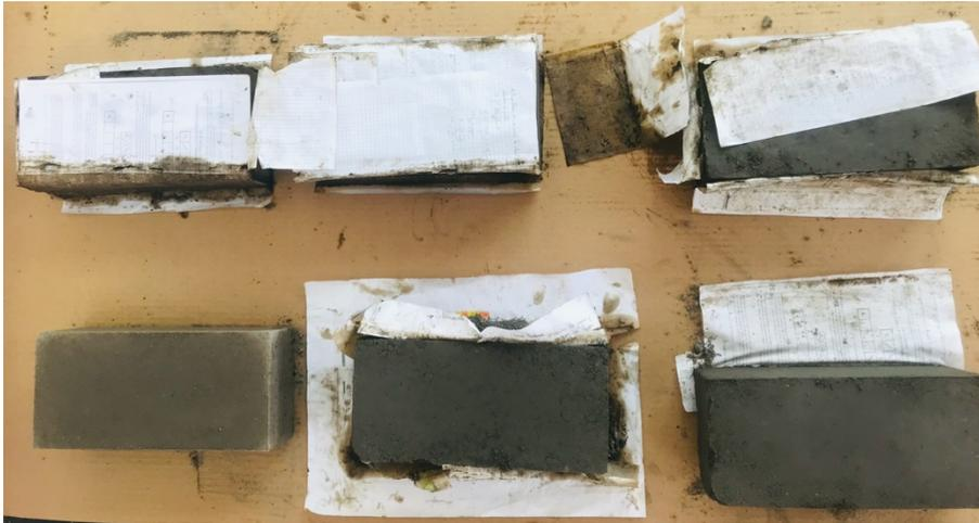
*Nota:* Adaptado de Trabajo de Fin de Titulación. En la mayoría de los bloques se coloca papel con aceite quemado, se comprobó que facilita el desmolde por *Torres (2021)*
