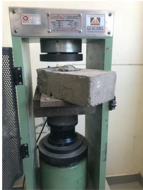
*Nota:* Adaptado de Trabajo de Fin de Titulación, se logra observar que el BTC no se deforma en su totalidad por Torres (2021)
