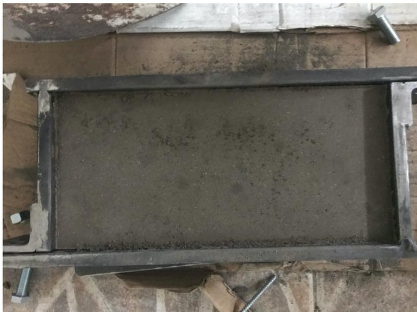
*Nota:* Adaptado de Trabajo de Fin de Titulación. Por ser un molde con pernos se tiene precaución al retirar ya que la mezcla contiene plasticidad y es necesario evitar las paredes del acero se unan al BTC y ocasionen imperfecciones por
